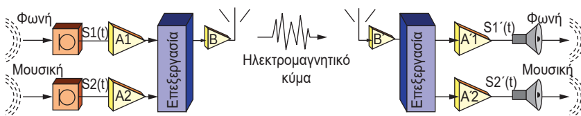
Σχήμα 3.2.5: Επεξεργασία του σήματος για ασύρματη ζεύξη. Το σήμα θα μετατραπεί σε ηλεκτρομαγνητικό κύμα
