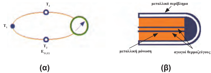
Σχήμα 2.4.2. (α) Κύκλωμα θερμοζεύγους και (β) θερμοζεύγος με μεταλλική μόνωση
