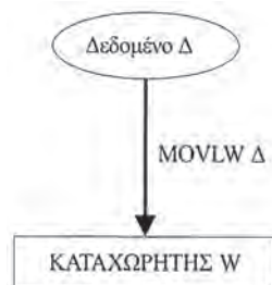
Σχήμα 5.7 Φόρτωση του καταχωρητή W με ένα δεδομένο Δ με την εντολή MOVLW Δ.
