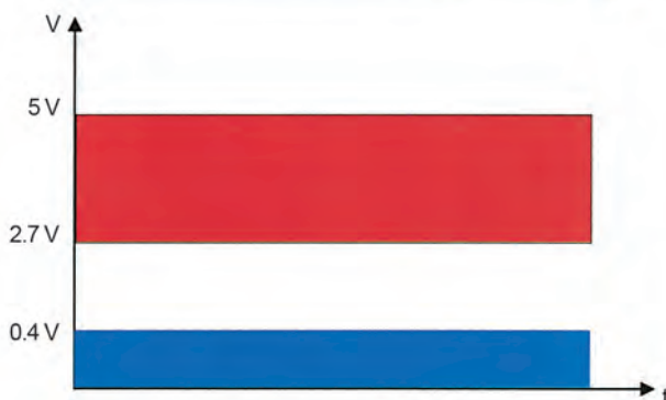
Σχήμα 1.4.4 Αποδεκτές τιμές για τις τάσεις εξόδου
