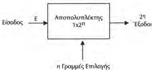
Σχήμα 4.3.1 Αποπολυπλέκτης 1 \times 2^n
