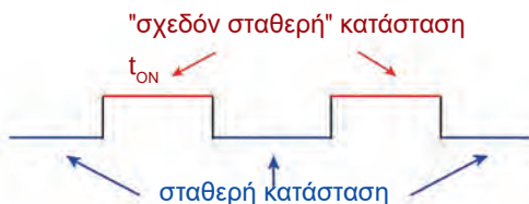
Σχήμα 12.1.1 Παλμοί που παράγονται από κύκλωμα ασταθή πολυδονητή
