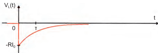
Σχήμα 10.16. Το διάγραμμα της τάσης του πηνίου σε συνάρτηση με το χρόνο, για κύκλωμα διακοπής ρεύματος πηνίου
