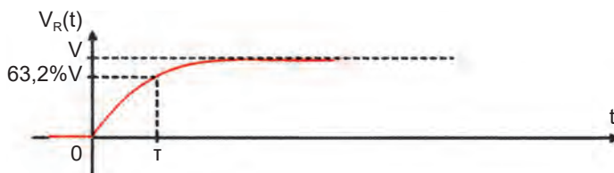
Σχήμα 10.13. Το διάγραμμα της τάσης του αντιστάτη σε συνάρτηση με το χρόνο, για το κύκλωμα αποκατάστασης ρεύματος σε πηνίο
