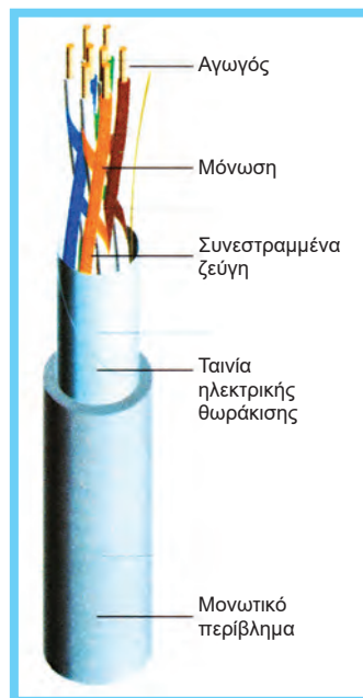
Σχήμα 3.1.1 Θωρακισμένο καλώδιο με πολλαπλά συνεστραμμένα ζεύγη χαλκινων αγωγών.
