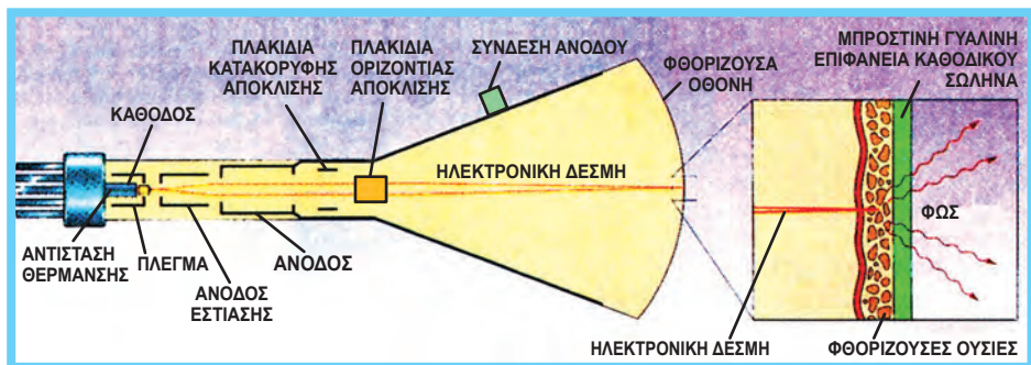
Σχήμα 6.3.4 Ο μονόχρωμος καθοδικός σωλήνας. Στα δεξιά λεπτομέρεια της φθορίζουσας επιφάνειας.
