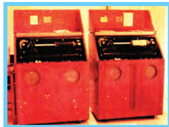
Σχήμα 2.11.1 Το αναλογικό τηλεομοιότυπο (φαξ) του 1935. Από το Μουσείο Τηλεπικοινωνιών του ΟΤΕ.
