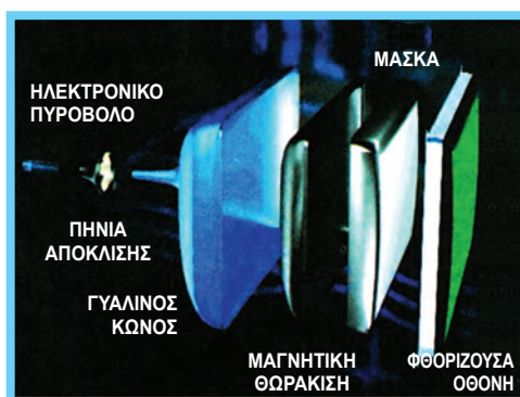
Σχήμα 6.3.5 Τα μέρη του σύγχρονου καθοδικού σωλήνα. Η εκτροπή της ηλεκτρονικής δέσμης γίνεται με μαγνητικό πεδίο από τα πηνία απόκλισης που βρίσκονται εξωτερικά αμέσως μετά το ηλεκτρονικό πυροβόλο.
