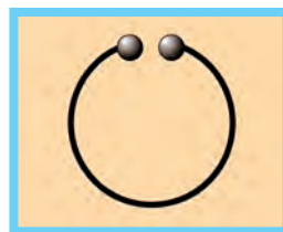
Σχήμα 2.8.2 Ο δέκτης (ανιχνευτής) του Χερτς.
