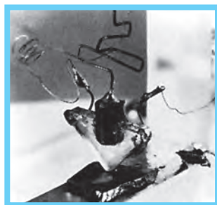
Σχήμα 2.13.3 Το πρώτο τρανζίστορ το 1948.
