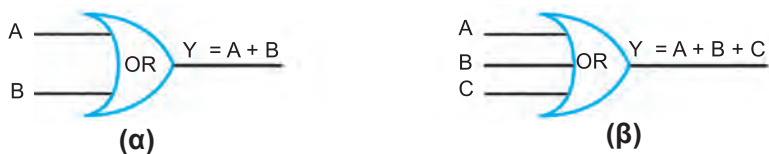
Σχήμα 7.4.6 Συμβολισμός πύλης OR (α) δύο εισόδων, (β) τριών εισόδων
