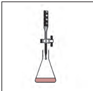
Εικ. 3.20 Ογκομέτρηση με προχοΐδα
