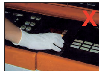
Εικ. 4.9. Δεν επιτρέπεται στο ΒΑΕ να αγγίζει το χειριστήριο ενός μηχανήματος φορώντας μολυσμένα γάντια
