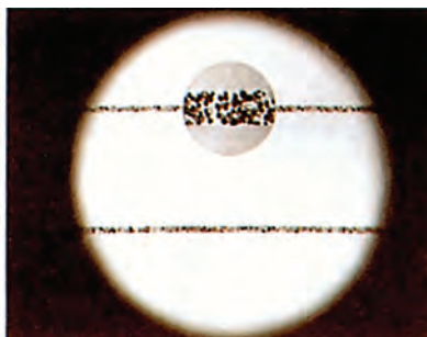
Σχήμα 8.5 Αριστερά σχηματική παράσταση της δομής του ακτινολογικού φιλμ. Στη δεξιά φωτογραφία, απεικονίζεται το φωτογραφικό γαλάκτωμα φιλμ διπλής επίστρωσης. Στην ένθετη κυκλική μεγέθυνση μια μικροφωτογραφία του γαλακτώματος.
