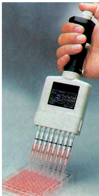
8.6 Πολυκάναλη πιπέτα και πλάκα μικροβυθισμάτων για τους προσδιορισμούς ELISA
