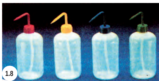
1.8 Πλαστικοί υδροβολείς, 1.9 Στήλη απιονισμένου νερού 1.10 Συσκευή για παροχή νερού υπό πίεση σε περίπτωση ατυχήματος
