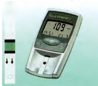
2.13 Μικροαναλυτής ξηράς χημείας και μικροταινία για προσδιορισμό γλυκόζης στο αίμα
