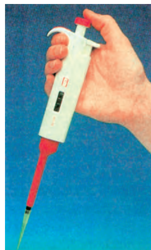
3.4 Αυτόματη πιπέττα ρυθμιζόμενου όγκου με ρύγχος (εύρος 50-200 \mu L).
