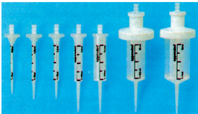
4.7 Ρύγχη διαφόρων μεγεθών, για τις αυτόματες επαναληπτικές πιπέττες.
