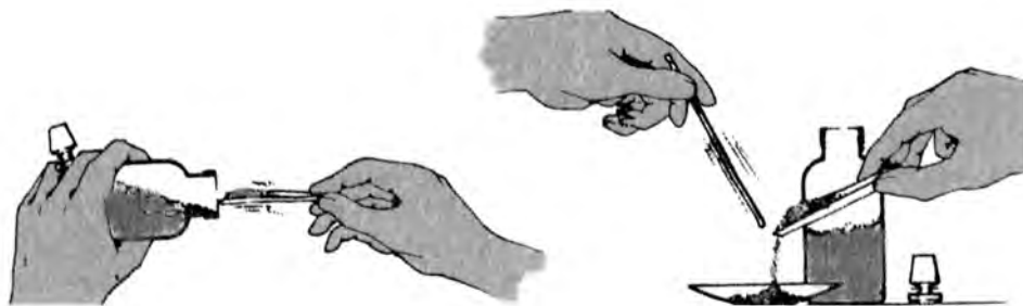
Εικόνα 1.16 Μεταφορά ποσότητας στερεής ουσίας από φιάλη σε κάψα.
