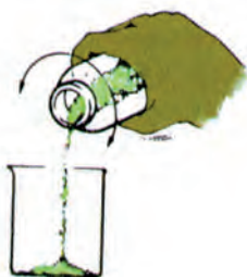
Εικόνα 1.17: Μεταφορά στερεής ουσίας από φιάλη σε ποτήρι ζέσεως.
