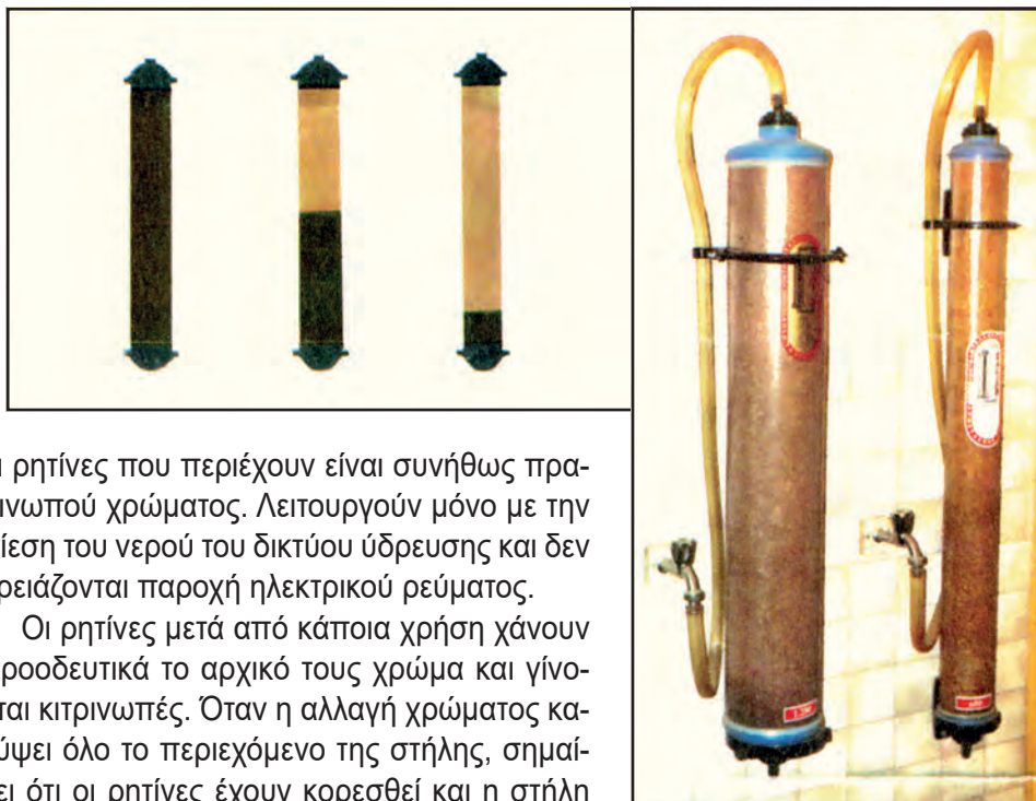
Εικόνα 2.2: Στήλες απιονισμού: (1) πλήρης, (2,3) χρησιμοποιημένες και (4) σε σύνδεση.
