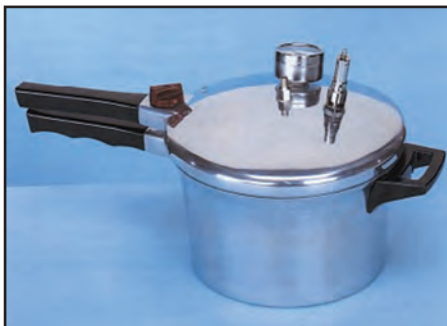
Εικ. 3.17. Συσκευή πολυμερισμού ακρυλικής ρητίνης.
