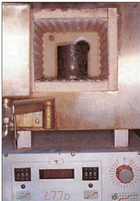
Εικ. 7.2. Ο δακτύλιος τοποθετείται στο κέντρο του φούρνου αποκήρωσης.
