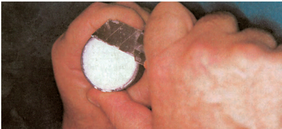
Εικ. 7.1: Μ' ένα νυστέρι αφαιρούμε την επιφανειακή κρούστα από την άνω πλευρά του δακτυλίου.
