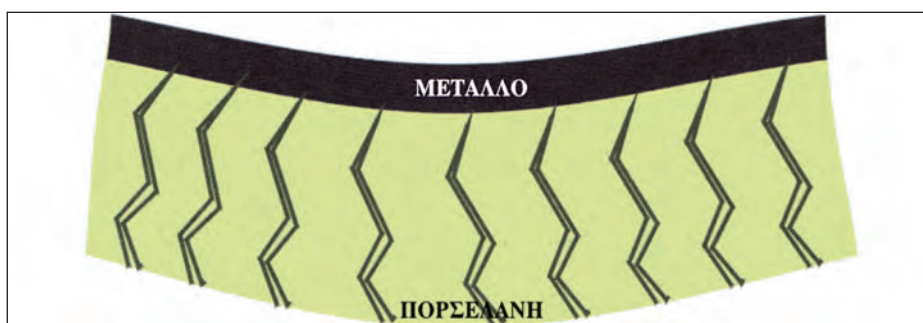
Εικ. 4.5: Η πορσελάνη σπάζει εύκολα σε κάμψη της μεταλλοκεραμικής επιφάνειας.
