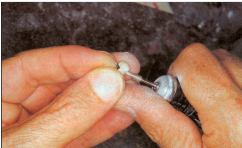
Εικ. 8.26: Με διαμάντι τροχίζουμε τη στεφάνη.
