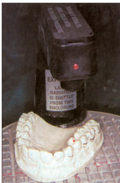
Εικ. 5.7: Διακρίνεται πάνω στο εκμαγείο η κόκκινη κηλίδα της φωτεινής ακτίνας της συσκευής.
