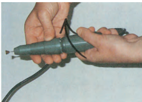
Εικόνα 7.13(β): Συγκράτηση και σταθεροποίηση του μικροεργαλείου με περιστροφή.
