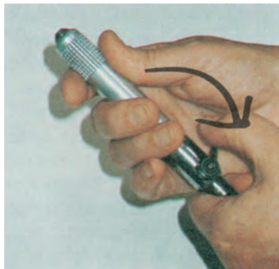
Εικόνα 7.12. (α): Άνοιγμα του σημείου τοποθέτησης του μικροεργαλείου στην υποδοχή της ευθείας.
