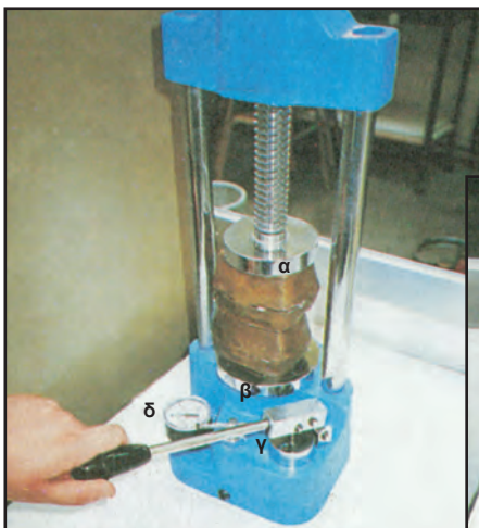
Εικόνα 7.26.: Υδραυλικό πίεστρο. (α): Επάνω πλάκα της συσκευής. (β): Κάτω πλάκα της συσκευής. (γ): Μοχλός της αντλίας. (δ): Μανόμετρο.
