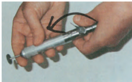
Εικόνα 7.12. (γ): Συγκράτηση και σταθεροποίηση του μικροεργαλείου με μετακίνηση της πεταλούδας.
