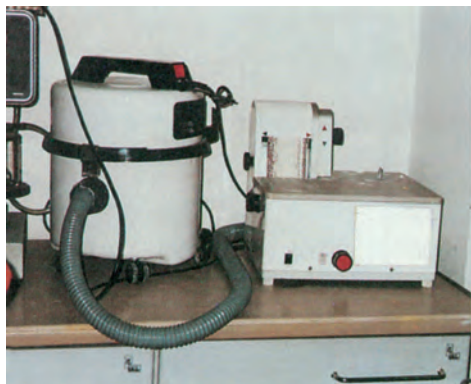
Εικόνα 7.6.: Συσκευή κοπής γύψου που λειτουργεί χωρίς νερό.
