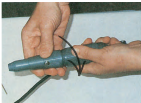
Εικόνα 7.13(α): Άνοιγμα του σημείου τοποθέτησης του μικροεργαλείου στην υποδοχή της ευθείας με περιστροφή.
