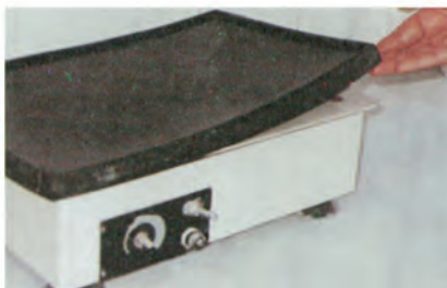
Εικόνα 7.2(β): Αφαίρεση καλύμματος από το δονητή.
