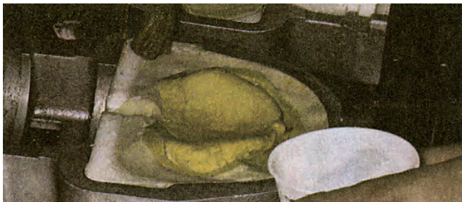
Εικόνα 11.3 Τοποθέτηση διαχωριστικού πριν το στοιβαγμό της ακρυλικής ρητίνης
