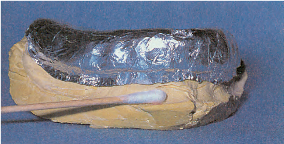
Εικ. 11.1 Επάλειψη διαχωριστικού υλικού σε εκμαγείο
