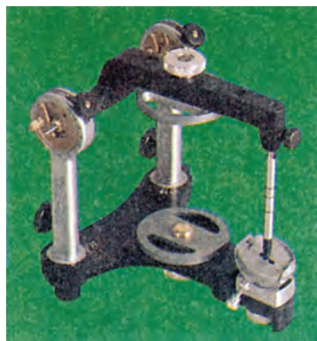
Εικόνα 7.1: Ημιπροσαρμοζόμενος Αρθρωτήρας Hanau
