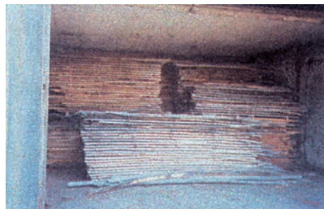
Εικ. 8.2 Λανθασμένη στοιβάξη ξυλείας
