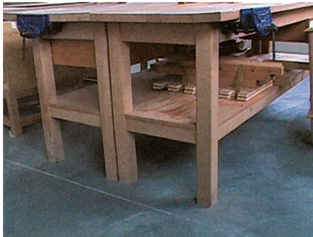
Εικ. 2.8 Στα πόδια του πάγκου εργασίας αναπτύσσονται τάσεις αξονικής θλίψης
