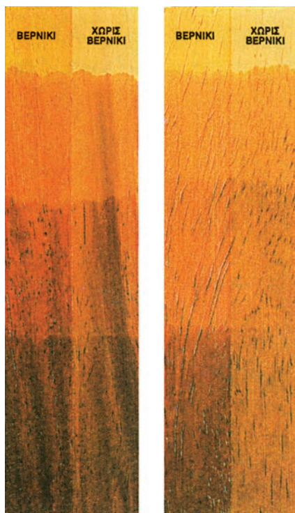
Δοκιμή με βαφή βασισμένη σε πιγμέντα
