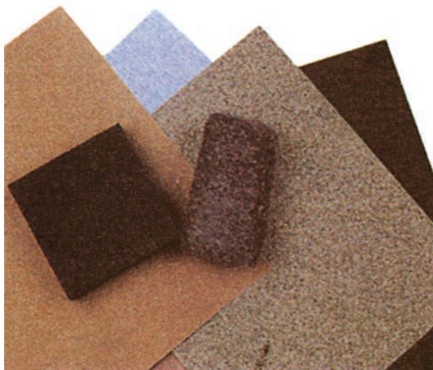
Δείγματα μέσων λείανσης (από την κορυφή αριστερά): με γρανάτη, οξειδίο του αλουμινίου, ανθρακοπυρίτιο και ταμπόν λείανσης
