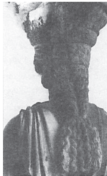
Εικόνα 2.3 Όξινη προσβολή και γυψοποίηση Καρυάτιδας.
