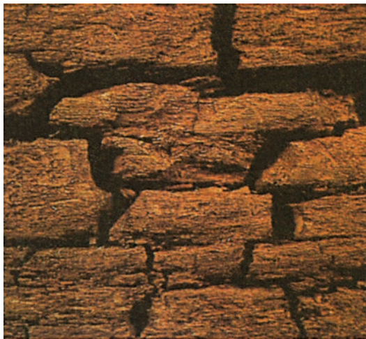
Εικόνα 2.1 Προσβολή ξύλου από διάφορα είδη μυκήτων.
