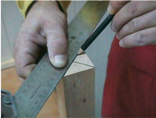
Εικ. 10.2 Εύρεση κέντρου εγκάρσιας επιφάνειας.
