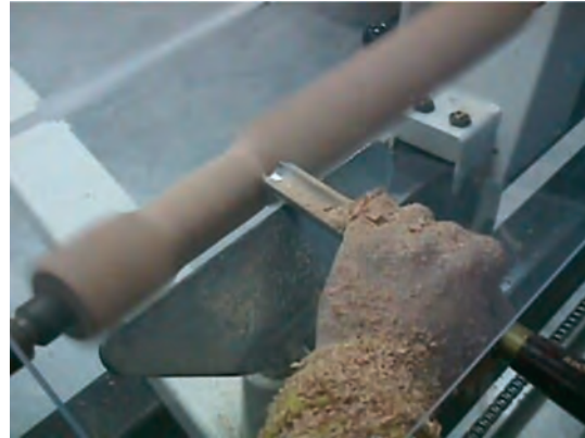
Εικ. 10.3 Τόνρευση ξύλου με καμπύλο σκαρπέλο.
