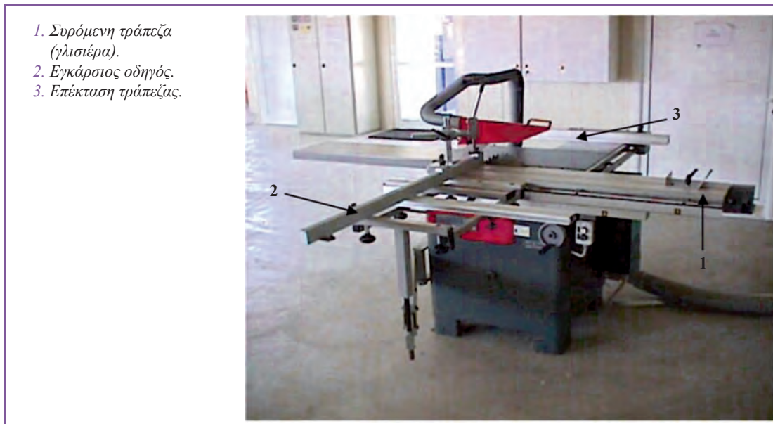
Εικ. 4.4 Δισκοπρίονο τεμαχισμού ξυλοπλακών.
