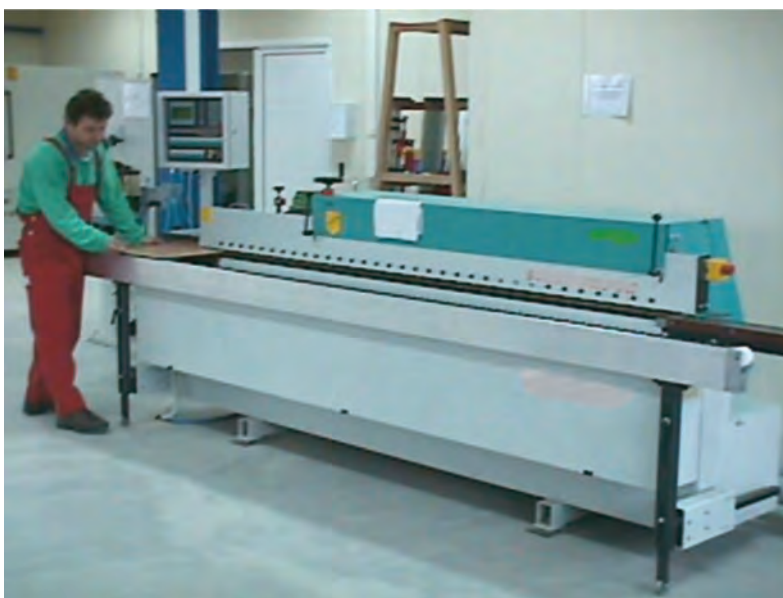
Εικ. 13.7 Τοποθέτηση ξυλοπλάκας στη συγκολλητική περιθωρίων.
