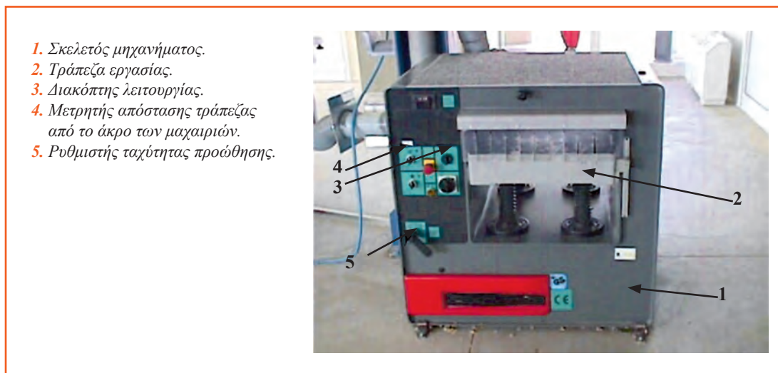
Εικ. 6.3 Τα κύρια μέρη του ξεχονδριστήρα.
