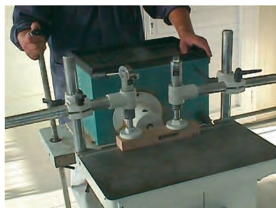
Εικ. 1.6 Διάνοιξη τρύπας σε μορσοτρύπανο.
