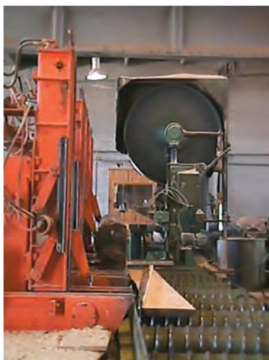
Εικ. 3.2 Ταινιοπρίονο κύριας πρίσης.
