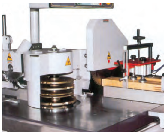
Εικ. 16.7 Πρίση εγκάρσιας επιφάνειας ξυλοτεμαχίου.
