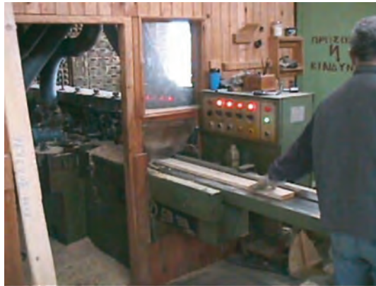
Εικ. 16.5 Τροφοδοσία ραμποτέζας με πιστή ξυλεία.
