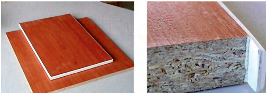
Εικ. 13.1 Ξυλοπλάκες με συγκολλημένα περιθώρια ταινίας PVC 3mm
