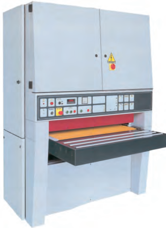
Εικ. 14.7 Τριβείο με πλατιά ταινία λείανσης.
