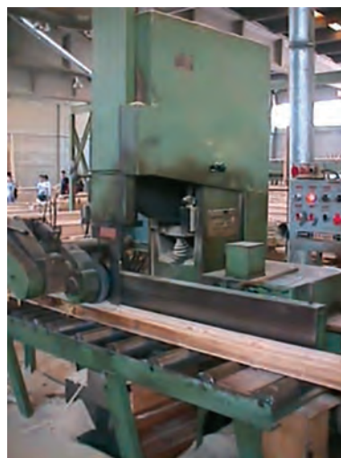
Εικ. 3.3 Ταινιοπρίονο επανάπρισης μεγάλου βάθους.
