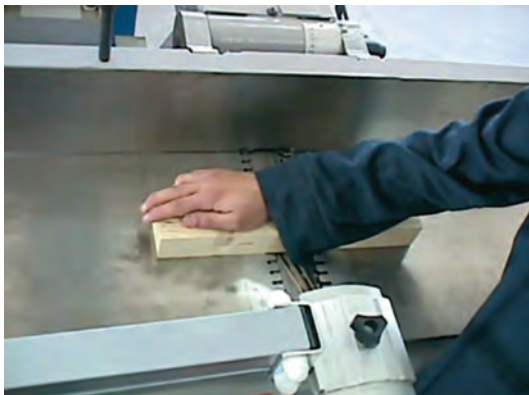
Εικ. 2.3 Επικίνδυνος χειρισμός της πλάνης. Ο χειριστής έχει ξεχειλωμένα μανίκια και δεν τοποθέτησε τα προστατευτικά.
