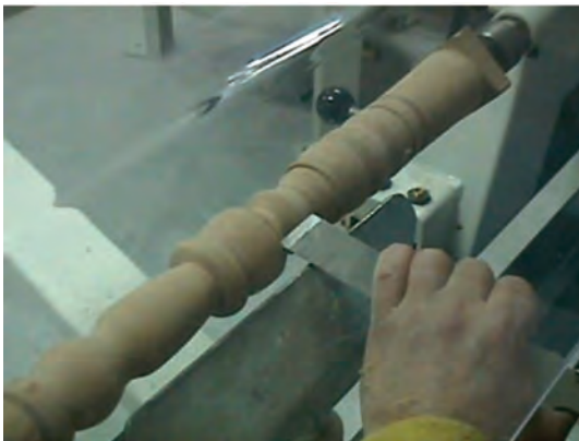
Εικ. 10.4 Δημιουργία μορφών με σκαρπέλο.
