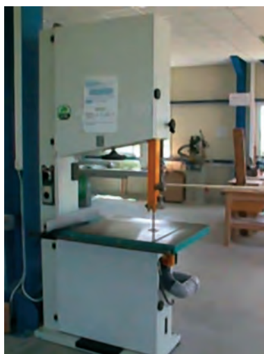
Εικ. 3.4 Ταινιοπρίονο επανάπρισης μικρού βάθους επιπλοποιείων, κτλ.
