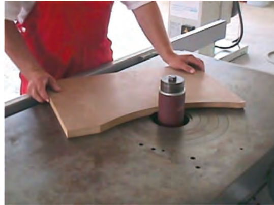
Εικ. 8.10 Λείανση καμπύλων επιφανειών με τριβείο κυλίνδρον τοποθετημένο σε άξονα της σβούρας.
