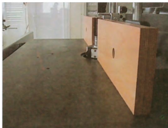
Εικ. 8.6 Ευθυγράμμιση και ρύθμιση των οδηγών.
