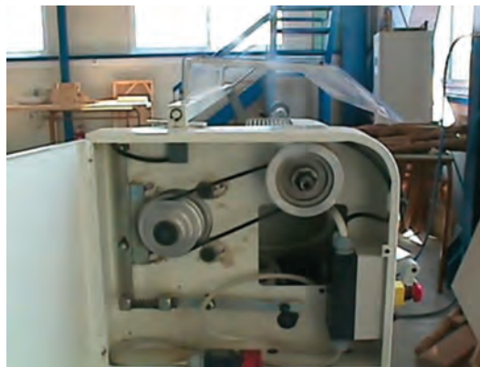
Εικ. 2.1 Σύστημα μετάδοσης της κίνησης με ιμάντα σε τόρνο.
