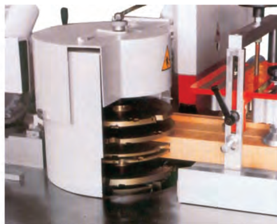
Εικ. 16.8 Δημιουργία μόρσων στην εγκάρσια επιφάνεια ξυλοτεμαχίου.
