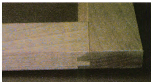
Εικ. 4.67., 4.68. Διαμόρφωση της εσωτερικής πλευράς του πλαισίου με διακοσμητικό «εργαλείο» (αριστερά). Με συμπληρωματικό εργαλείο διαμορφώνονται τα άκρα στα μόρσα, ώστε να επιτύχουμε τέλεια εφαρμογή των δυο στοιχείων (δεξιά).
