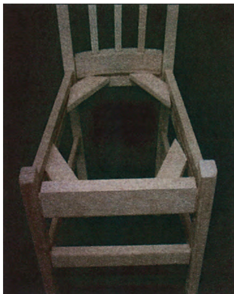
Εικ. 7.6. Φωτογραφία σκελετού καρέκλας. Διακρίνονται οι ενισχύσεις στις συνδέσεις (τριών διευθύνσεων με μόρσο).
