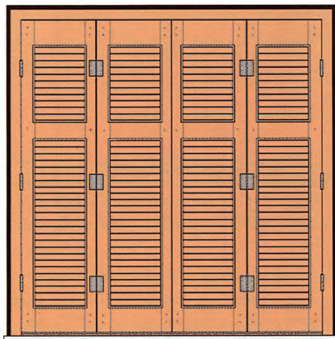
Εικ. 8.12. Εξωτερική όψη γαλλικού εξωφύλλου σε παράθυρο. Υπάρχουν 4 φύλλα, που όταν ανοίγει διπλώνουν ανά δύο, δεξιά - αριστερά στο λαμπά του τοίχου. Για τη σύνδεση κάσας - εξωφύλλου χρησιμοποιήθηκαν γαλλικοί μεντεσέδες, για τη σύνδεση των φύλλων μεταξύ τους επίπεδοι μεντεσέδες (πλάκα). Διακρίνονται και οι καβίλιες στις συνδέσεις.
