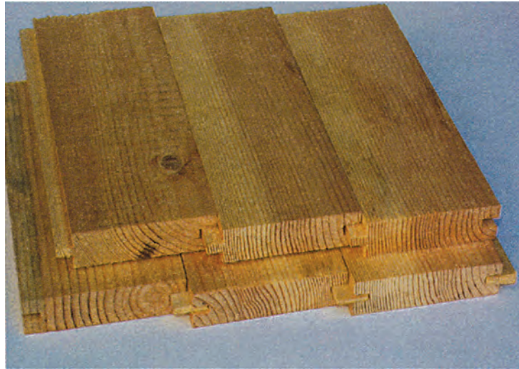
Εικ. 3.43. Σύνδεσμοι πλάτους με αρσενικό – θηλυκό (επάνω), με γκινισόπηχη (κάτω).
