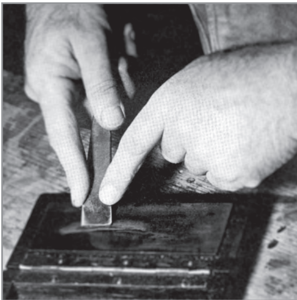
Εικ. 2.1. Ακόνισμα ίσιου σκαρπέλου σε ακόνι (λαδάκονο)
