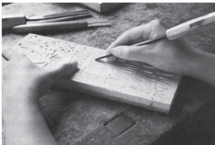
Εικ. 5.9. Εφαρμογή σκαρπέλων σε χάραγμα
