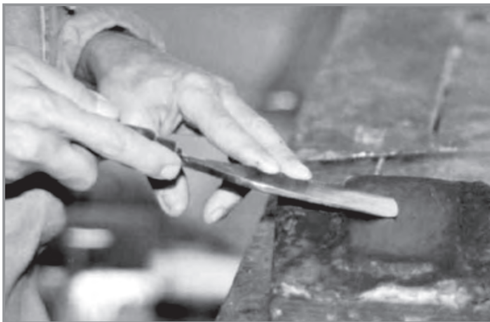
Εικ. 2.2. Ακόνισμα σγρόμπιας και ακριβής θέση χεριών
