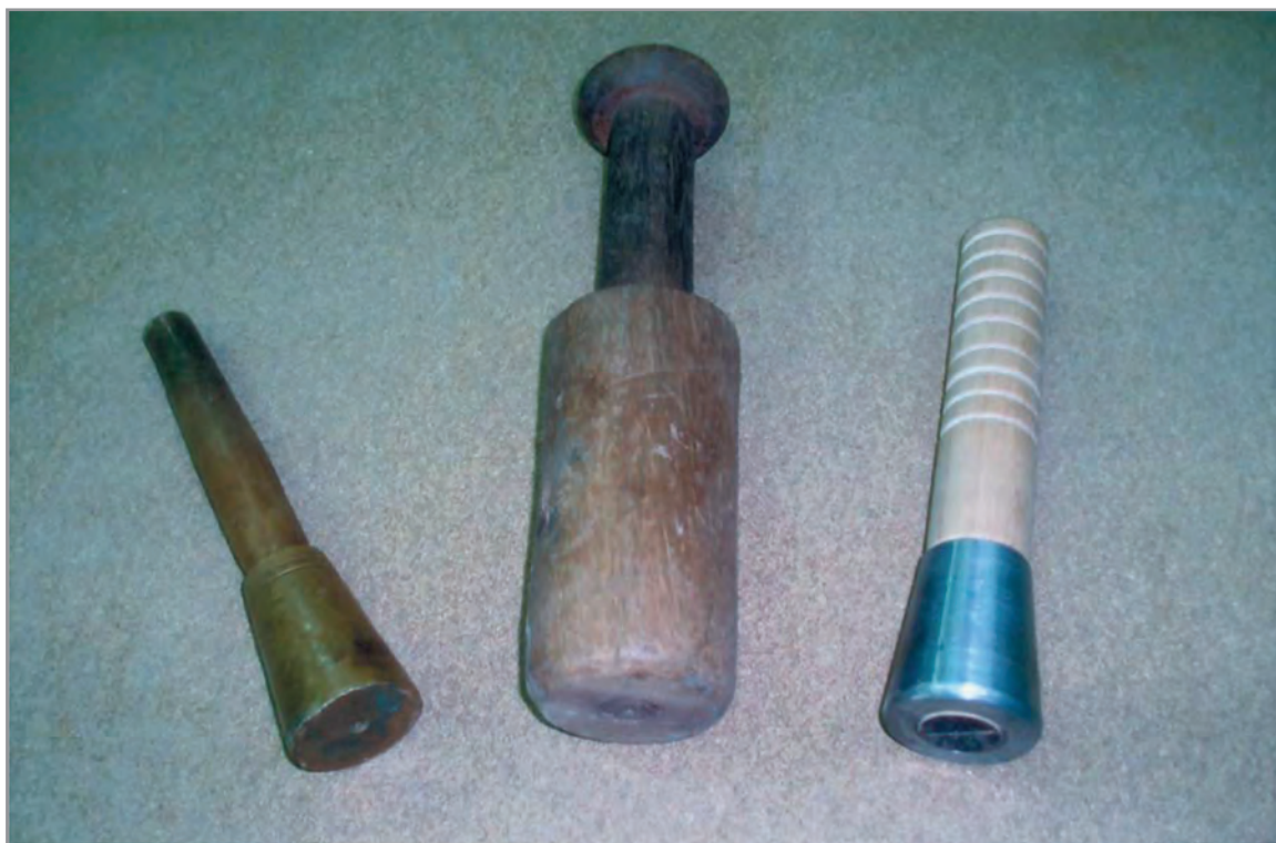
Εικ. 1.7. Ματσόλα ξύλινη και μεταλλική
