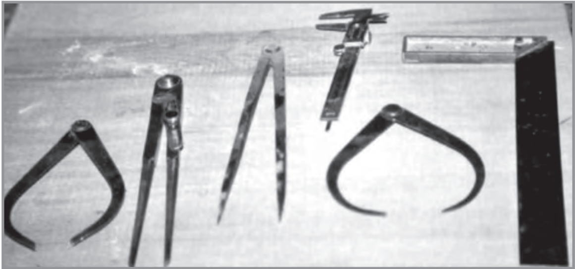
Εικ. 4.1. Όργανα σχεδίασης μοτίβων: Από αριστερά προς τα δεξιά: 4 τύποι κουμπάσων, παχύμετρο και γωνία
