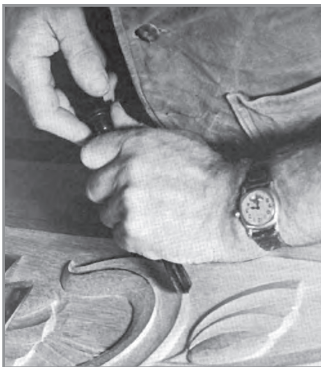
Εικ. 5.4. Τρόπος εργασίας με τρίγωνο σκαρπέλο
