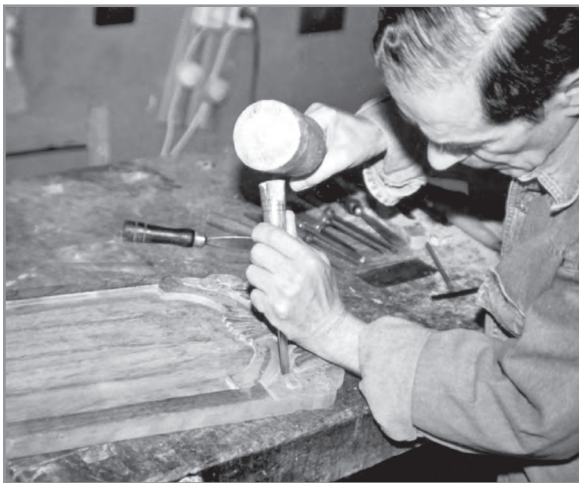
Εικ. 5.2. Τάκιασμα με σκαρπέλο και ματσόλα
