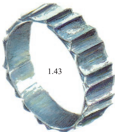
Εικ. 1.43 Αξονομετρικό σχέδιο βραχιολιού υπό κλίση 30^\circ/30^\circ .
