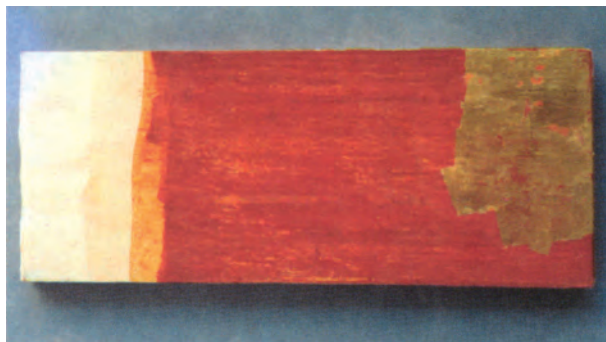
Εικόνα 11.1.: Δείγμα προετοιμασμένου ξύλινου υποστρώματος στο οποίο διακρίνεται ειδική προετοιμασία με “μπόλλο” και δίπλα επικάλυψη με στιλβωτό φύλλο χρυσού.
