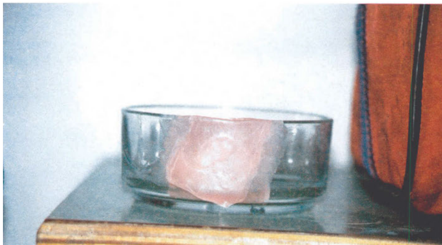
Διαδικασία συμπλήρωσης γυάλινου αντικειμένου με τη χρήση καλουπιού από οδοντιατρικό κερί.
