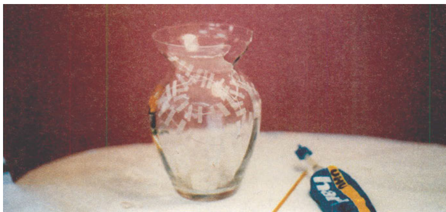
Διαδικασία συγκόλλησης γυάλινου αντικειμένου με magic tape και με εποξειδική ρητίνη.
