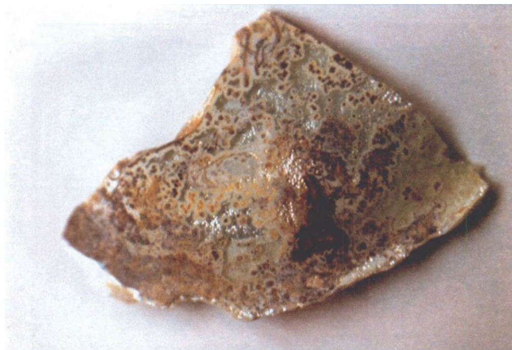
Διάβρωση επιφάνειας γυαλιού με φυλλώδη διάβρωση, με βελονισμούς και με ιριδισμούς.
