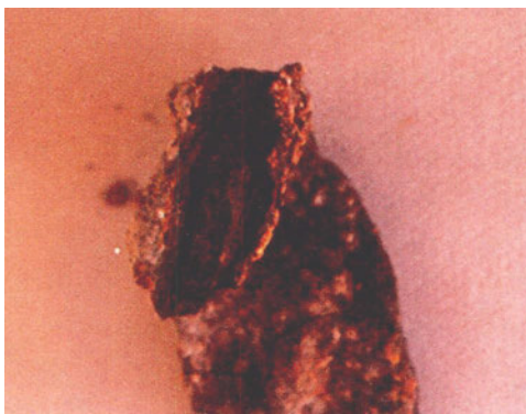
Λεπτομέρεια όπου παρατηρεί κανείς ότι ο μεταλλικός πυρήνας έχει αντικατασταθεί από μαύρο μαγνητίτη.
