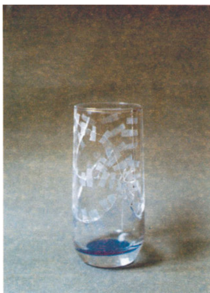
Διαδικασία συγκόλλησης γυάλινου αντικειμένου με magic tape και με εποξειδική ρητίνη.
