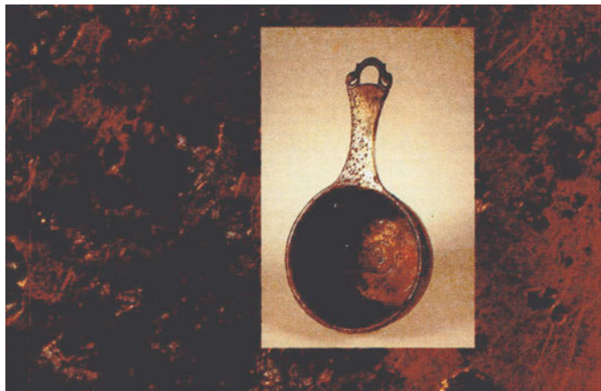
Μπρούτζινο δοχείο. Σε ορισμένες περιοχές του αντικειμένου παρατηρείται επιλεκτική δράση διάβρωσης.
