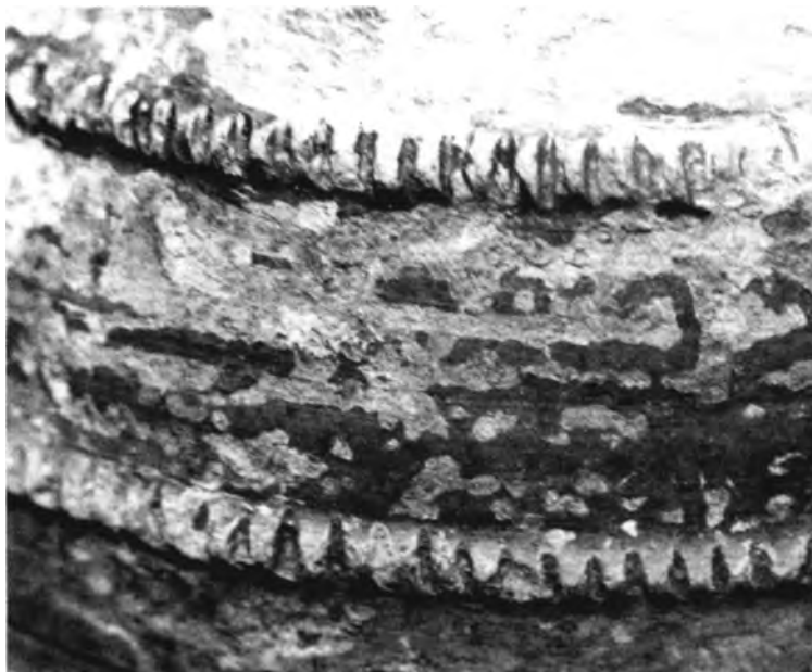
Διάβρωση κεραμικού αντικειμένου από την κρυστάλλωση διαλυτών αλάτων.
