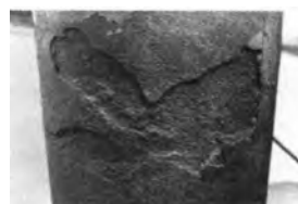
Διάβρωση κεραμικού αντικειμένου από την κρυστάλλωση διαλυτών αλάτων.
