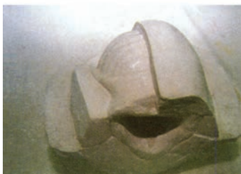
Κατασκευή σπαστού καλουπιού της πίσω πλευράς.
