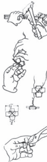
Διαδικασία κατασκευής πεταλούδας.
