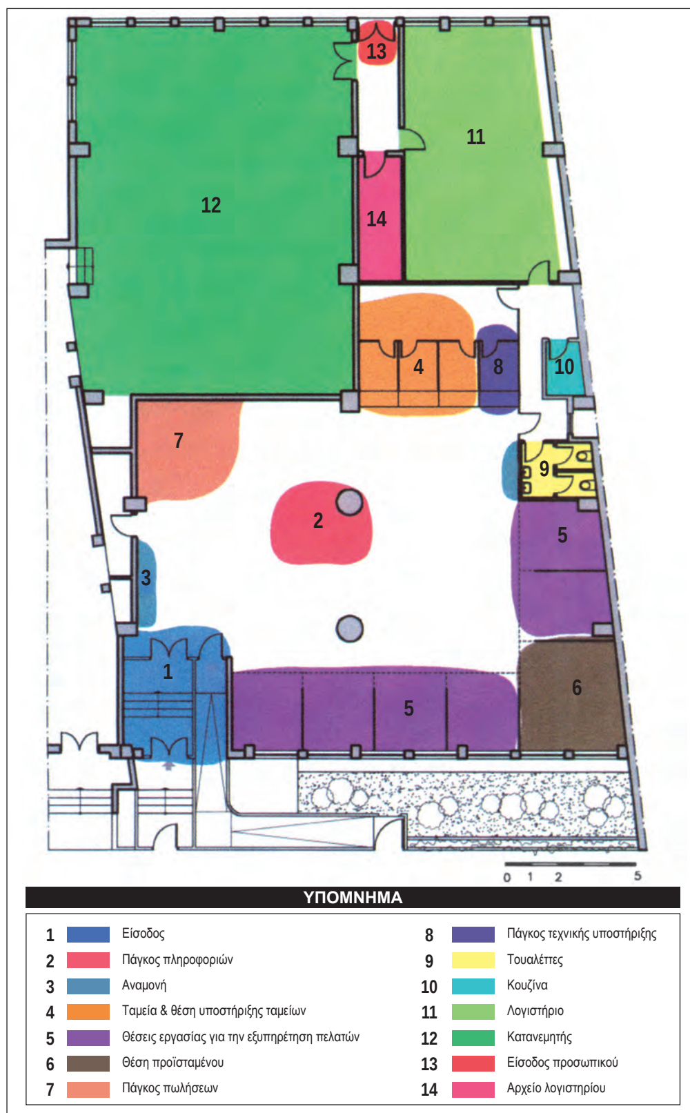
Εικ. 5. Κάτοψη καταστήματος γραφείου ΟΤΕ: Λειτουργικές ενότητες
