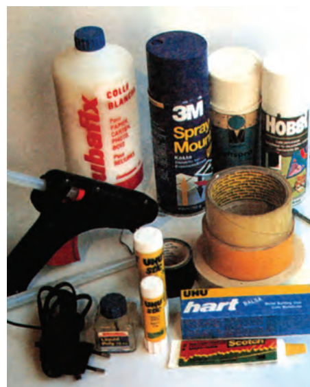
δ.23 Πιστόλι θερμοκόλλησης με σιλικόνη, λευκή κόλλα, κόλλες σε σπρέι, στικ και σωληνάρια και κολλητικές ταινίες.
