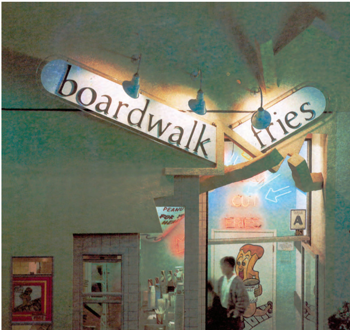
β.116 Ετερόφωτη επιγραφή, στην οποία τα φωτιστικά σώματα καθορίζουν τη διαμόρφωση της εικόνας.
