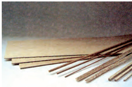
Δ.21 Μπάσα σε φύλλα και ράβδους, σε διάφορα πάχη και διατομές.
