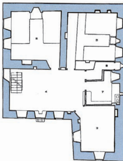
49. Συνθήκες μικροκλίματος στην παραδοσιακή αρχιτεκτονική, που εξασφαλίζονται με τους χοντρούς εξωτερικούς πέτρινους τοίχους στο βορρά και το ελαφρύ τζαμωτό τοιχοπέτασμα στο νότο. Το αρχοντικό Μουσλή στη Μακρινίτσα.
