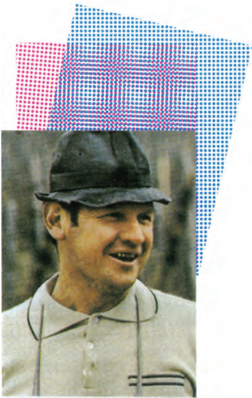
9.12 Φωτογραφία που τυπώθηκε με χρώματα των οποίων οι μοίρες του ράστερ δεν είχαν τη σωστή κατεύθυνση, με αποτέλεσμα να δημιουργηθεί το φαινόμενο του μοναρέ ή αλλιώς ψάθας
