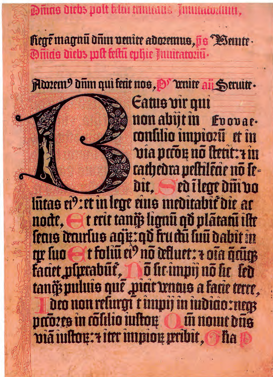
2.4 Σελίδα από το Ψαλτήρι, που τυπώθηκε στο τυπογραφείο του Γουτεμβέργιου. Το στοιχείο του δίχρωμου πρωτογράμματος αποτελείται από δύο μεταλλικά τμήματα. Το ένα προορίζεται για την εκτύπωση του γράμματος και το άλλο για τη διακόσμηση.
