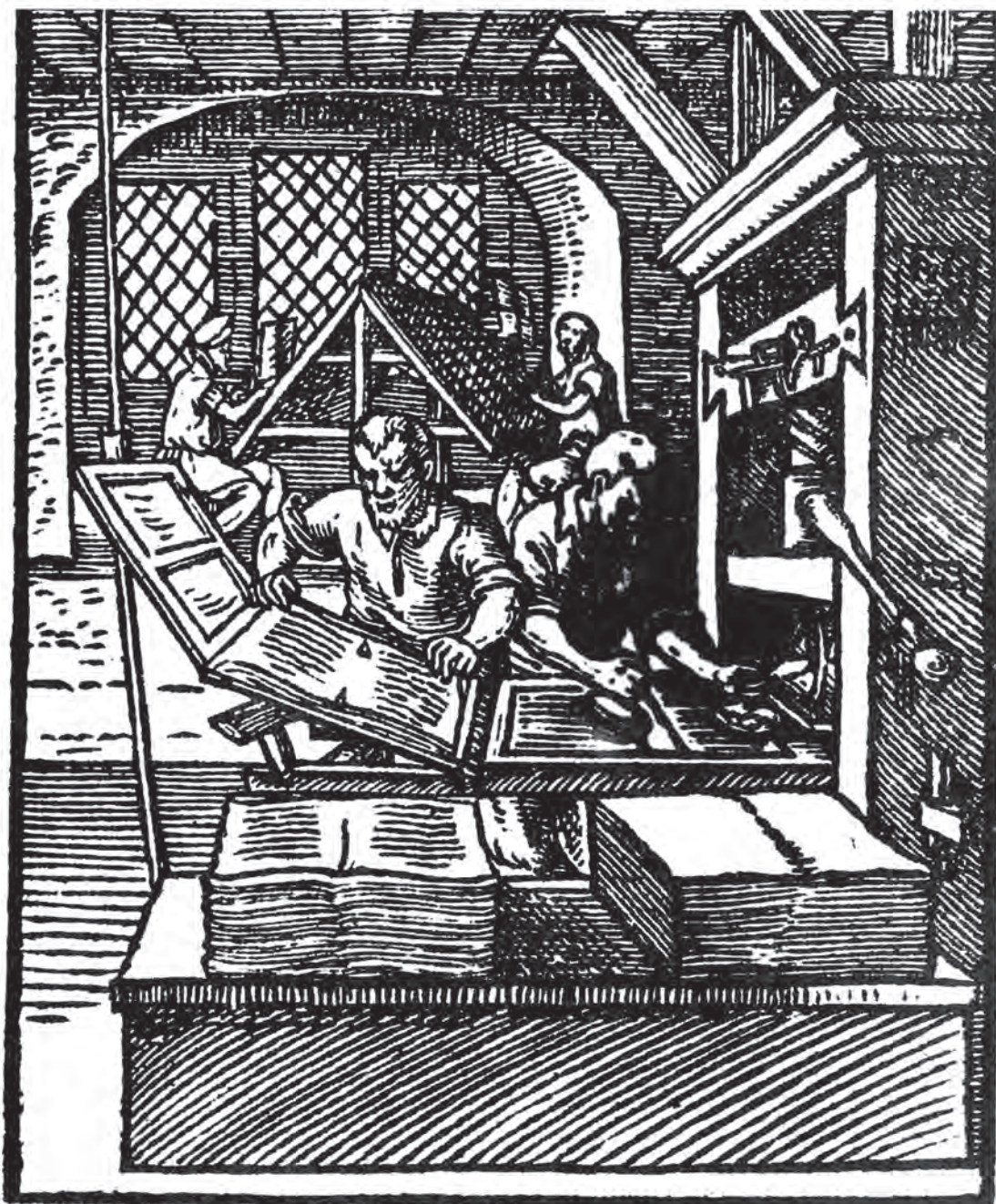
2.7 Ξυλογραφία του 16ου αιώνα, που εικονίζει τυπογραφικό πιεστήριο.
