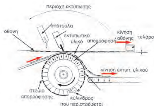
5.11 Σχηματική παράσταση εκτύπωσης κυλινδρικής μηχανής μεταξοτυπίας
