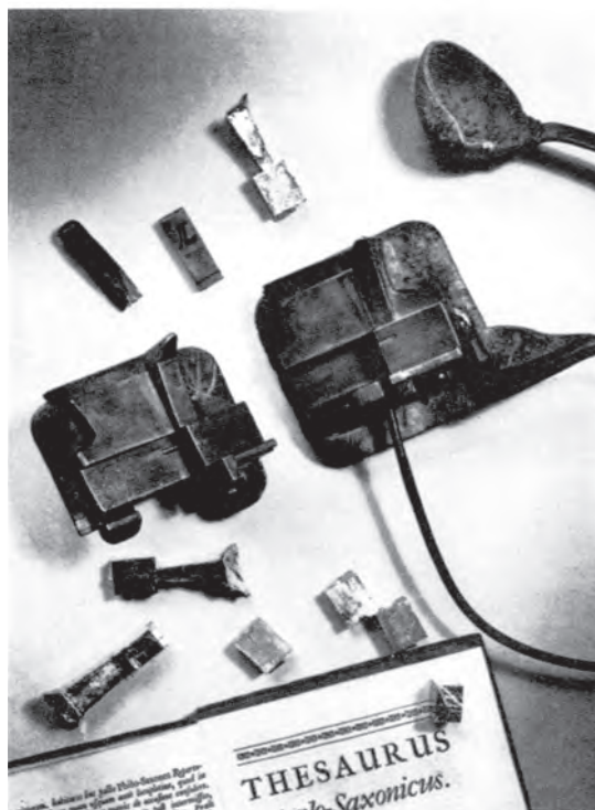
2.2 Τα δύο μέρη του καλουπιού ενός στοιχείου ενώνονται σφιχτά για να δεχθούν το υγρό μέταλλο. Μετά τη χύτευση και τη στερεοποίηση του κράματος, το τυπογραφικό στοιχείο απομακρύνεται με το άνοιγμα του καλουπιού.
