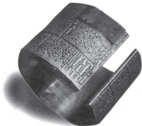
3.12 Τυπογραφικός κύλινδρος κατασκευασμένος με τη μέθοδο των στερεοτύπων
