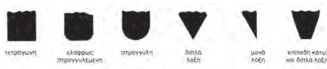
5.5 Σχηματική απεικόνιση, που παρουσιάζει διάφορες τομές από σπάτουλες μεταξοτυπίας
