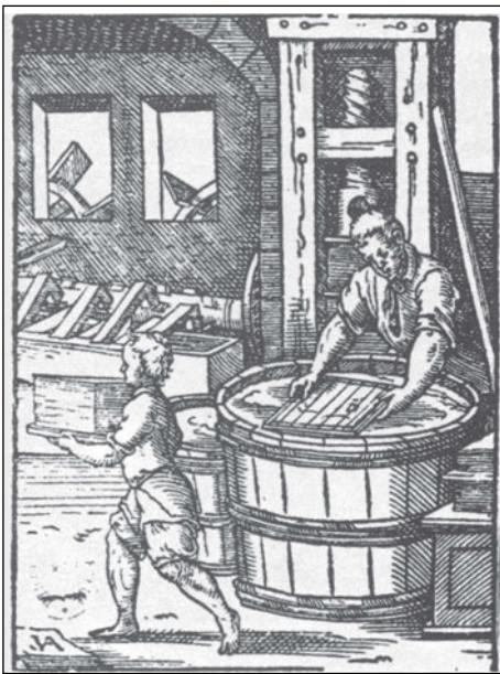
17.4 Διαδικασία κατασκευής χαρτιού: Ο χαρτοπολιτός από λινά ράκη απλώνεται πάνω σε συρμάτινο πλέγμα, για να στραγγίσει και να στερεοποιηθεί. Ξυλογραφία 16ου αιώνα.
