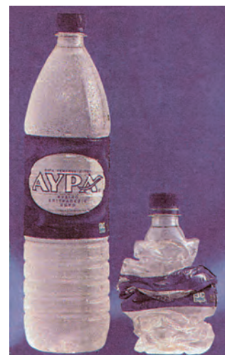
8.22 Η φιάλη pet είναι μια φιάλη που χρησιμοποιείται στη συσκευασία νερού και αναψυκτικών. Έχει πολλά πλεονεκτήματα, π.χ. είναι ελαφριά, φτηνή και διαφανής.
