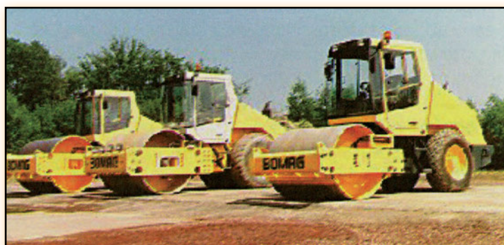
Σχήμα 1.21 Οδοστρωτήρες σε συμπίκνωση βάσης οδού
