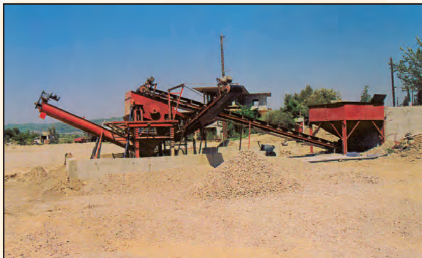
Σχήμα 2.8 Συγκρότημα παραγωγής αδρανών
