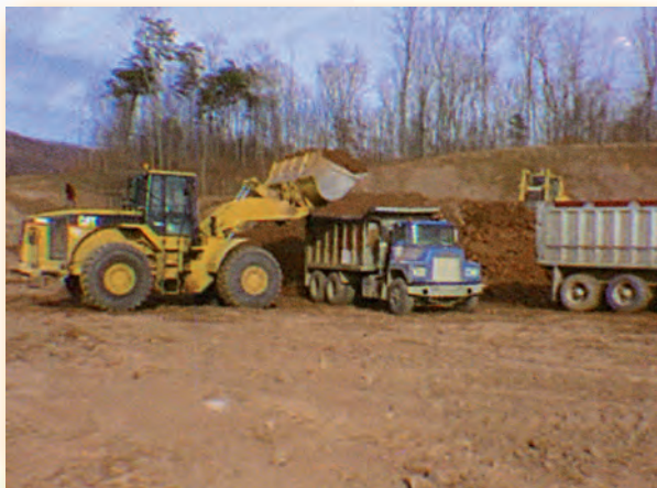
Σχήμα 3.11. Φορτωτής σε ώρα εργασίας
