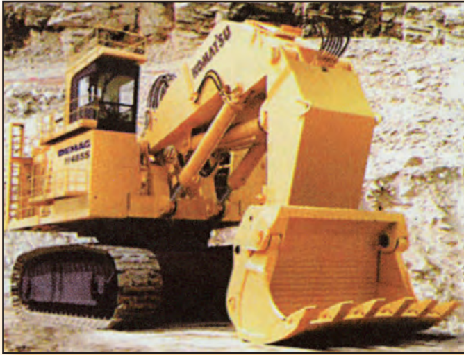
Σχήμα 3.1. Εκσκαφέας μετωπικού πτύου
