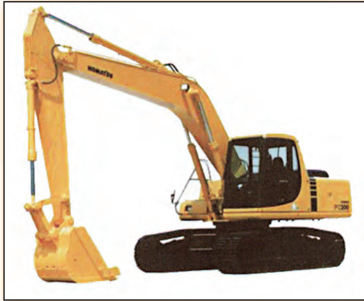
Σχήμα 3.2. Εκσκαφέας ανεστραμμένου πτύου (τσάπα)
