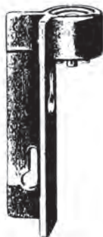
Εικ. 31 Ειδική σφαιρική αεροστάθμη για την κατακορύφωση των ακοντίων.
