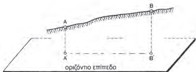
Σχ. 39 Ορθή προβολή των σημείων μιας ευθυγραμμίας.
