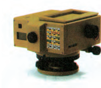
Εικ.26 Ο ψηφιακός χωροβάτης A2000 της Leica.
