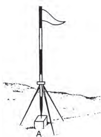
Σχ. 26 Ακόντιο με το τριποδίσκο στήριξης.
