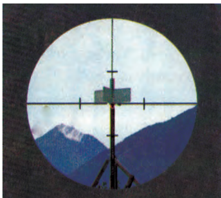
Εικ. 11 Το σταυρόνημα όπως φαίνεται μέσα από το τηλεσκόπιο την ώρα της σκόπευσης.
