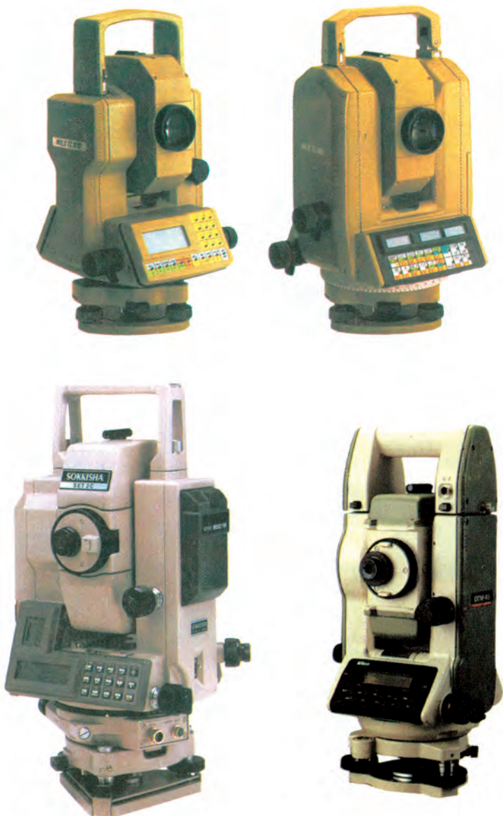
Εικ. 19 Γεωδαιτικοί σταθμοί των εταιρειών Leica (WILD), Sokkisha, Nikon.
