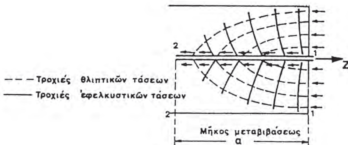
Σχήμα 16.1 Μεταβίβαση δυνάμεων κατά την εξόλκευση ράβδου οπλισμού.
