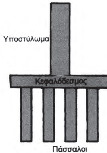
Σχήμα 5. Θεμελίωση υποστυλώματος με ομάδα πασσάλων.
