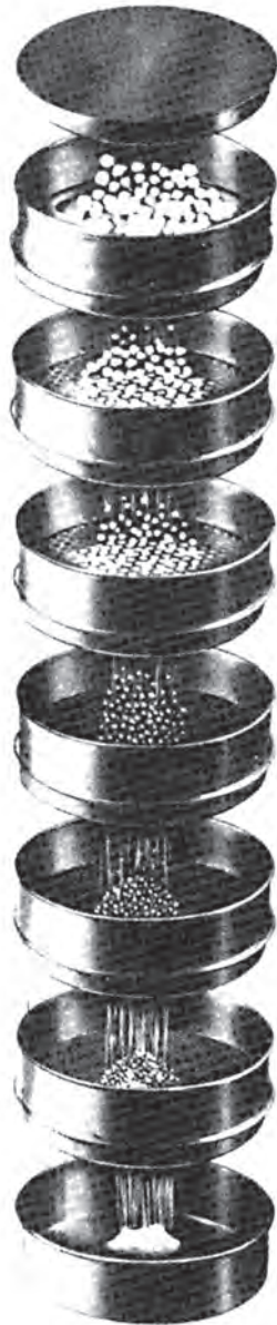
Σχήμα 14.1 Διαδοχικά κόσκινα για τον διαχωρισμό βάσει του μεγέθους του κόκκου*.
