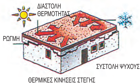
Σχήμα 8.13. Παραδείγματα θερμικών μεταβολών των δομικών στοιχείων.
