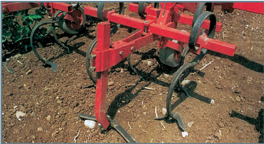
Εικόνα 4.4 Καλλιεργητής για σκάλιμα του εδάφους
