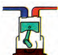
Σχήμα 4.1.3 Ερμητικός συμπιεστής Βαλβίδες αναρρόφησης και κατάθλιψης
