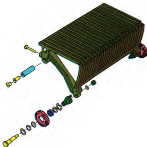
Σχέδιο B10 Σχηματική διάταξη τμημάτων σκαλοπατιού
