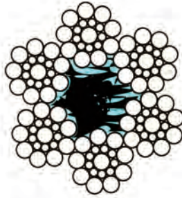
Σχέδιο 2.22 Συρματόσχοινο Seale με συρματίδια διαφορετικών διαμέτρων
