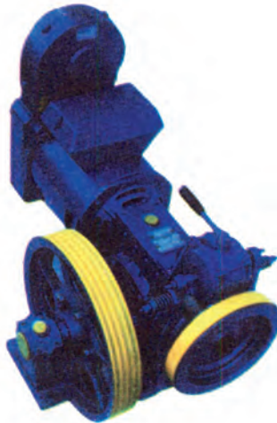
Σχέδιο 2.10 Ηλεκτρικός κινητήρας πάνω στον κινητήριο μηχανισμό
