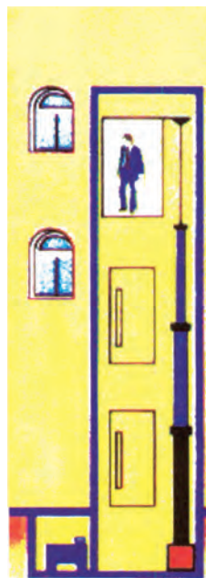
Σχέδιο 5.12 Χρησιμοποίηση πλάγιας άμεσης ανάρτησης
