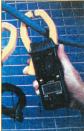
Εικόνα 2.19.γ Μετασχηματιστές εντάσεως.
