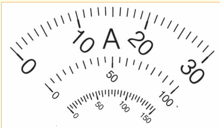
Εικόνα 2.16 Κλίμακα αμπερομέτρου τριών περιοχών μετρήσεων
