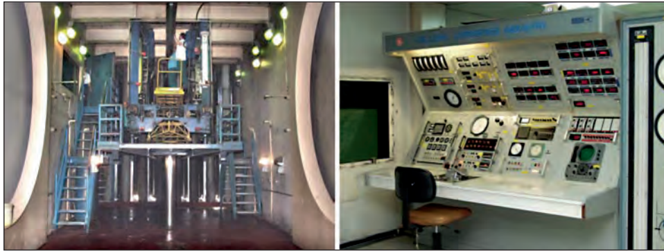
Σχήμα 2.30 Δοκιμαστήριο εμβολοφόρων κινητήρων και αίθουσα ελέγχου
