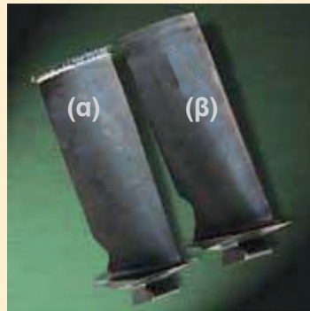
Σχήμα 3.134 (α) Συγκόλληση ακροπτερυγίου και (β) αποκατάσταση περιγράμματος μετά από μηχανουργική κατεργασία (τρόχισμα)
