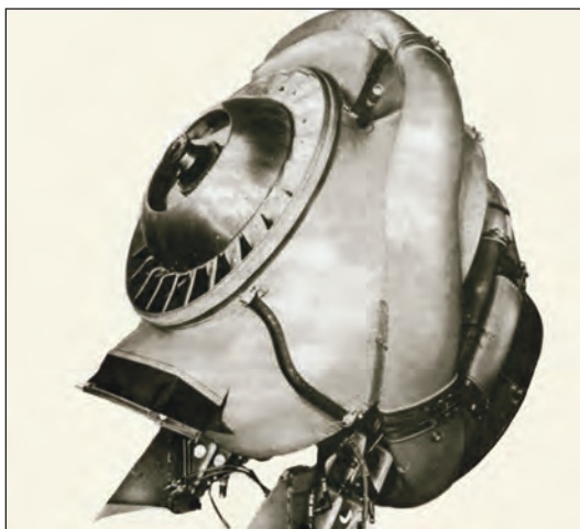
Σχήμα 2.43 Σύστημα ψύξης ακτινικού εμβολοφόρου κινητήρα ελικοπτέρου
