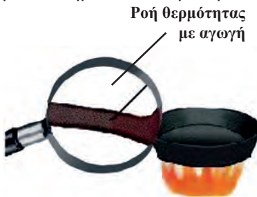
Σχήμα 1.8 Η θέρμανση της λαβής γίνεται μέσω «αγωγής»
