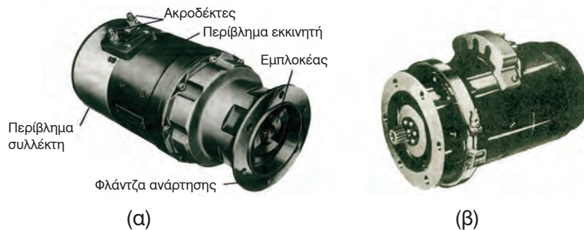
Σχήμα 3.42 Ηλεκτρικός εκκινητής (α) και εκκινητής γεννήτρια (β)
