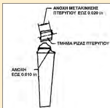
Σχήμα 3.74 (α) Ασφάλιση κινητών πτερυγίων, (β) περιοχές ελέγχου των κινητών πτερυγίων μετά την ασφάλισή τους στο δίσκο
