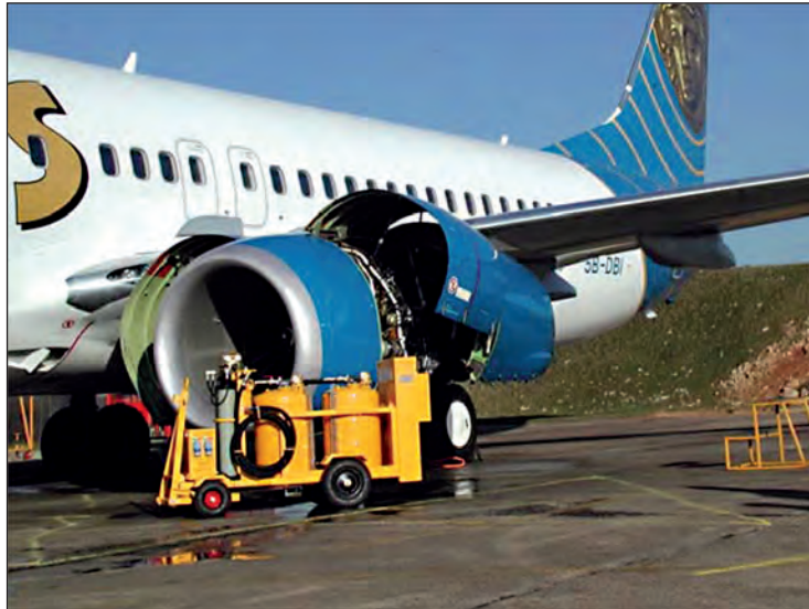
Σχήμα 3.3 Εξοπλισμός καθαρισμού κινητήρα
