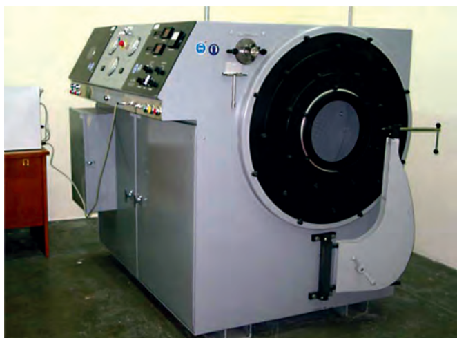
Σχήμα 3.20 Δοκιμαστήριο μέτρησης της επιφάνειας «σταθερών» βαθμίδων
