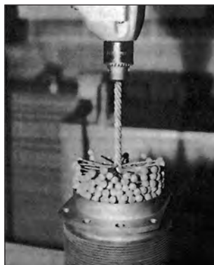
Σχήμα 2.24 Εκτράχυνση εσωτερικής επιφάνειας κυλίνδρου
