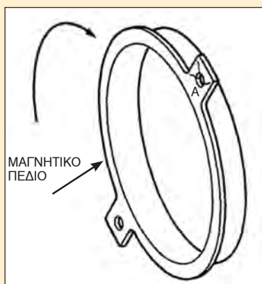
Σχήμα 3.129 Κρίσιμες περιοχές μαγνητικής επιθεώρησης ελάσματος (liner)
