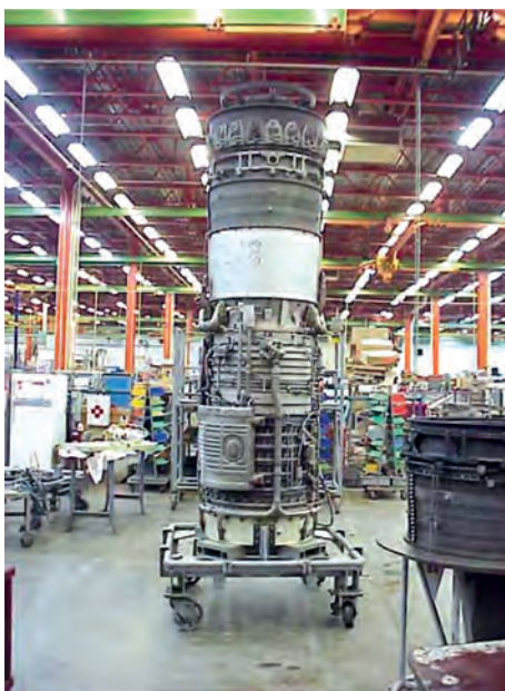
Σχήμα 3.6 Κινητήρας J79 στην κλίνη αποσυναρμολόγησης
