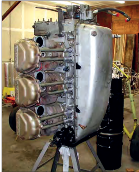
Σχήμα 2.9 Κινητήρας O-470 σε κλίση αποσυναρμολόγησης
