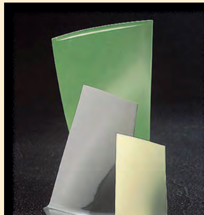
Σχήμα 3.135 Πτερύγια που έχουν υποστεί αντιδιαβρωτική προστασία με πούδρα «αλουμινίου»
