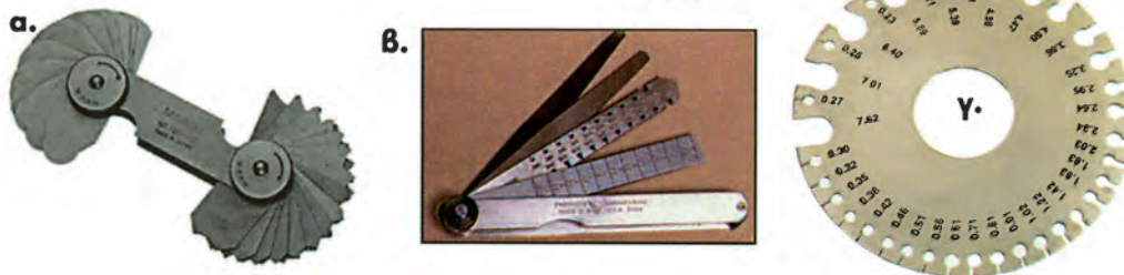
α) Ελεγκτήρας Ακτίνων Καμπυλότητας, β) Ελεγκτήρας Πλάτους Σχισμών, γ) Ελεγκτήρας Διαμέτρου Συρμάτων
