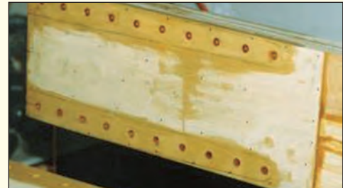
β) Κοντραπλακέ θαλάσσης με τα αποτυπώματα των οπών
