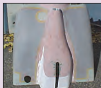
ε) Επίστρωση και Τρίψιμο με Υαλοϋφασμα
