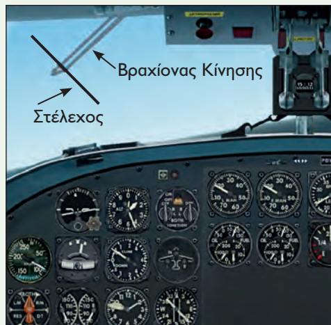
Σχήμα Α.12.3: Ρύθμιση Υαλοκαθαριστήρα
