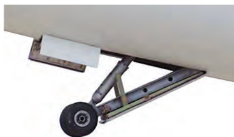
β) Κύλινδροι Απλής Ενέργειας Ουραίου Σκέλους Α/φους Concorde
