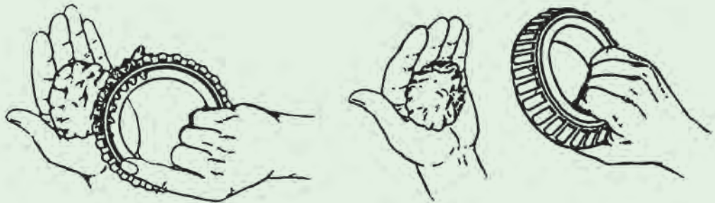
Σχήμα A.10.2: Επάλειψη Γράσου σε Τριβείς Τροχών Α/φους
