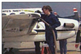
α) Πλήρωση Δεξαμενής Καυσίμου Πτέρυγας
