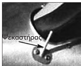
α) Αντιπάγωση Έλικας με Ψεκασμό Αλκοόλης
