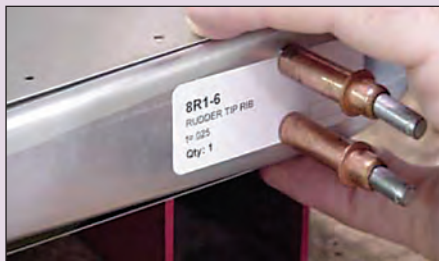
β) Τοποθέτηση εγκάρσιας Νεύρωσης στο Ακροπτερύγιο
