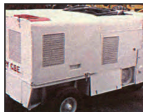
α) 28 Volt συνεχές και 128/208 Volt, 400 Hz, 60KVA
