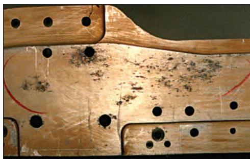
α) Επιφανειακή και β) Ενδοκρυσταλλική Διάβρωση
