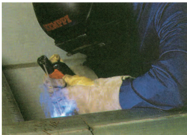
Σχήμα (6.51): Σωστά προστατευμένος ηλεκτροσυγκολλητής με άκαυστη φόρμα, γάντια και κράνος. Προσέξτε ότι κρατάει την τσιμπίδα και με τα δύο χέρια.
