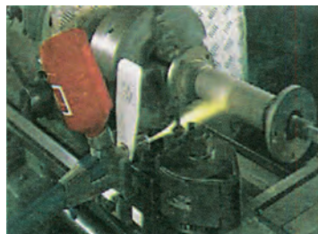
Σχήμα (11.3): (A) Επίδειξη αναγόμευσης μεταφορικού κοιλία σε σχολικό εργαστήριο με τη μέθοδο ψεκασμού (B) Διαδικασία αναγόμευσης εξαρτήματος με αυτόματη μηχανή ψεκασμού λιωμένης μεταλλικής σκόνης
