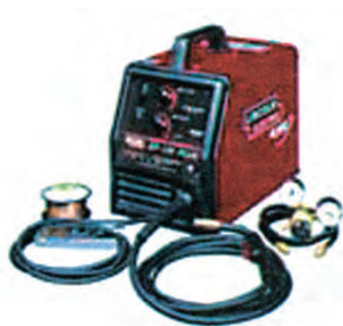
Σχήμα (9.11): Μικρή φορητή μηχανή MIG, έτοιμη με τα παρελκόμενά της, για τη συγκόλληση αλουμινίου σε συνεργείο που δεν εκτελεί συστηματικά κολλήσεις αλουμινίου.
