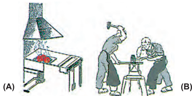
Σχήμα (10.8): (Α) Κλασσικός τύπος καμινιού με χειροκίνητο ή ποδοκίνητο φουσητήρα (Β) Η διαδικασία συγκόλλησης με σφυρηλάτηση
