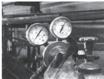
Σχήμα (5.21): Ρύθμιση της πίεσης εργασίας με το ρυθμιστικό κοχλίο του μανομετρικού εκτονωτή
