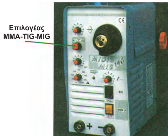
Σχήμα (6.37): Μικρή φορητή μηχανή CC/CV κατάλληλη για MMA, MIG/MAG, FCAW, TIG
