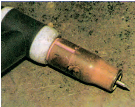
Σχήμα (6.4): Το μη αναλώσιμο ηλεκτρόδιο στην άκρη της τσιμπίδας
