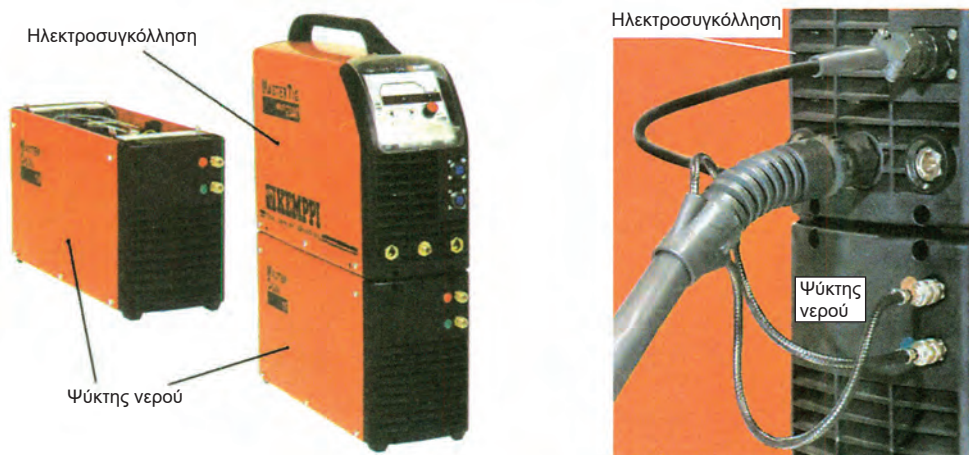
Σχήμα (6.33): Η σύνδεση υδρόψυκτης τσιμπίδας TIG πάνω στη μηχανή
