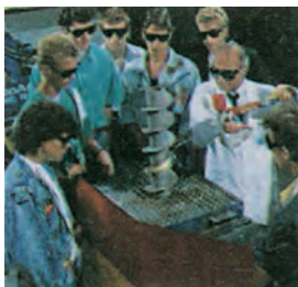
Σχήμα (11.3): (A) Επίδειξη αναγόμευσης μεταφορικού κοιλία σε σχολικό εργαστήριο με τη μέθοδο ψεκασμού (B) Διαδικασία αναγόμευσης εξαρτήματος με αυτόματη μηχανή ψεκασμού λιωμένης μεταλλικής σκόνης
