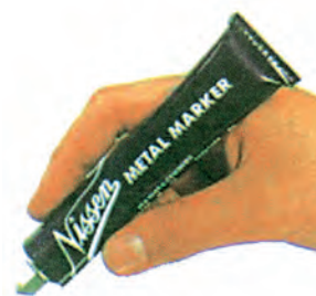
Σχήμα (5.26): Ειδικός μαρκαδόρος με ικανότητα γραφής ακόμη και σε μεταλλικές επιφάνειες που έχουν πολύ υψηλή θερμοκρασία ( 800-1000^\circ\text{C} )
