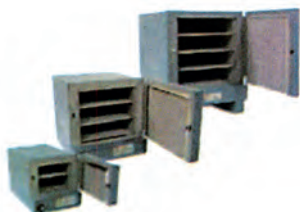
Σχήμα (8.30): Σταθεροί φούρνοι συντήρησης ή ξήρανσης βασικών ηλεκτροδίων
