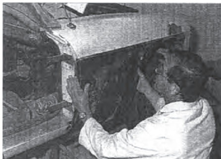
Σχήμα (5.49): Η δοκιμή του νέου φτερού στη θέση του παλιού
