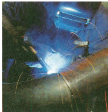
Σχήμα (6.15): Προσθήκη μετάλλου με σύρμα κατά τη MIG/MAG ή την FCAW
