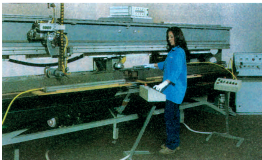
Σχήμα 2.6. Διαδικασία αυτόματης συγκόλλησης φύλλων χαλκού με χρήση υπερήχων
