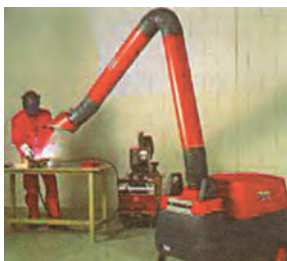
Σχήμα (6.46): Σταθερό σύστημα αναρρόφησης (υψηλής παροχής αέρα - χαμηλής υποπίεσης)
