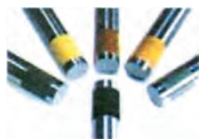
Σχήμα (9.15): Ο χρωματικός κώδικας των ηλεκτροδίων βολφραμίου
