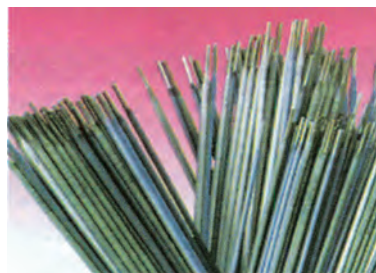
Σχήμα (6.11): Η μορφή επενδυμένων ηλεκτροδίων. Ο διαφορετικός χρωματισμός οφείλεται στο διαφορετικό είδος της πάστας.
