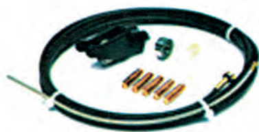
Σχήμα (9.10): Σετ συγκόλλησης αλουμινίου για μηχανές MIG. Περιλαμβάνει: μπεκ αλουμινίου, σωλήνα τεφλόν, ράουλα προώθησης σύρματος και ακροφύσιο εισόδου-εξόδου του σύρματος στο σωλήνα.
