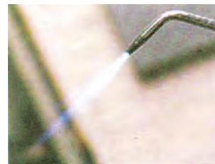
Σχήμα (5.23): Η φλόγα μετά τη ρύθμισή της (συνδεδεμένη)
