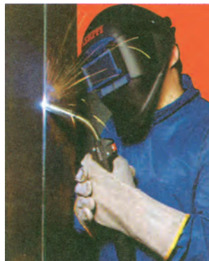
Σχήμα (6.15): Προσθήκη μετάλλου με σύρμα κατά τη MIG/MAG ή την FCAW
