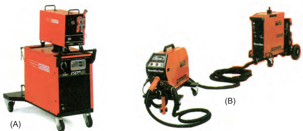
Σχήμα (6.35): (A) Τροφοδότης σύρματος τοποθετημένος πάνω στη μηχανή ηλεκτροσυγκόλλησης (B) Σε απόσταση από τη μηχανή
