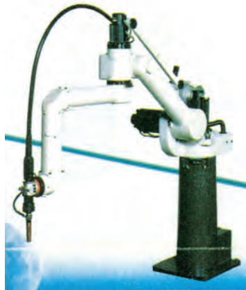
Σχήμα (9.23): Σύγχρονο ρομπότ 6 αξόνων (εκτελεί 6 διαφορετικές κινήσεις)
