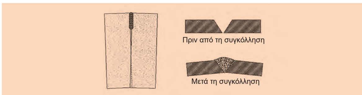
Σχήμα (7.9): Παραμορφώσεις λαμαρινών κατά την ηλεκτροσυγκόλληση
