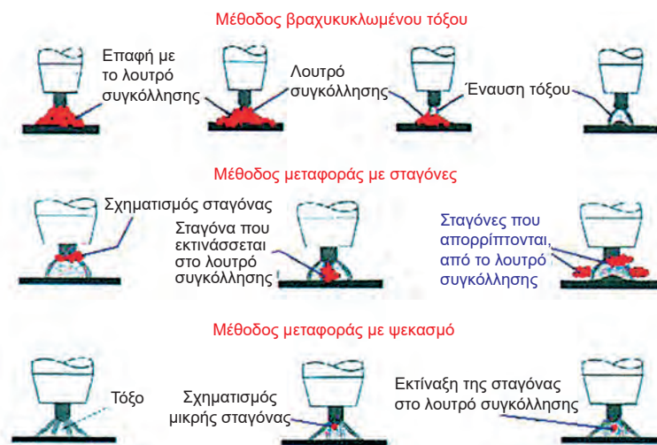
Σχήμα (9.6): Η μεταφορά βραχυκυκλωμένου τόξου, με σταγόνες και με ψεκασμό
