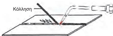
Σχήμα (5.35): Η κόλληση προηγείται του ακροφυσίου και ανεβοκατεβαίνει, ενώ ο καυστήρας κινείται σε κατεύθυνση ζιγκ-ζαγκ.
