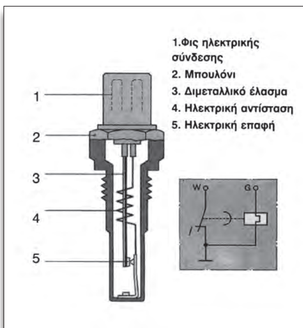
Σχήμα 4: Θερμικός χρονοδιακόπτης.
