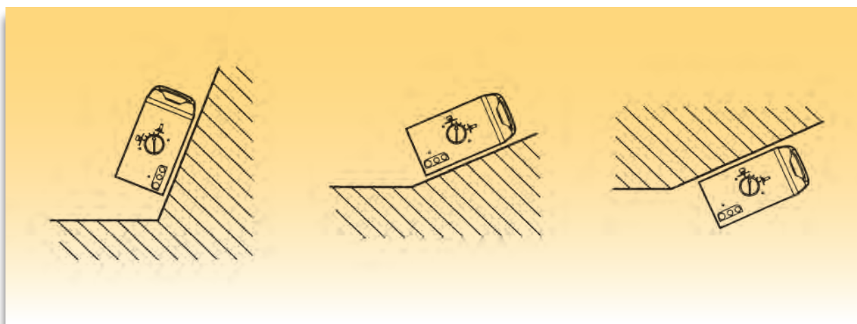
Σχήμα 10δ: Τοποθέτηση CD-changer με κλίση.
