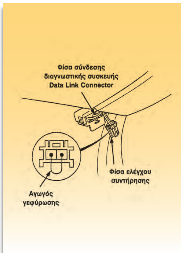
Σχήμα 4: Γεφύρωση των ακροδεκτών της φίσας για την αυτοδιάγνωση.
