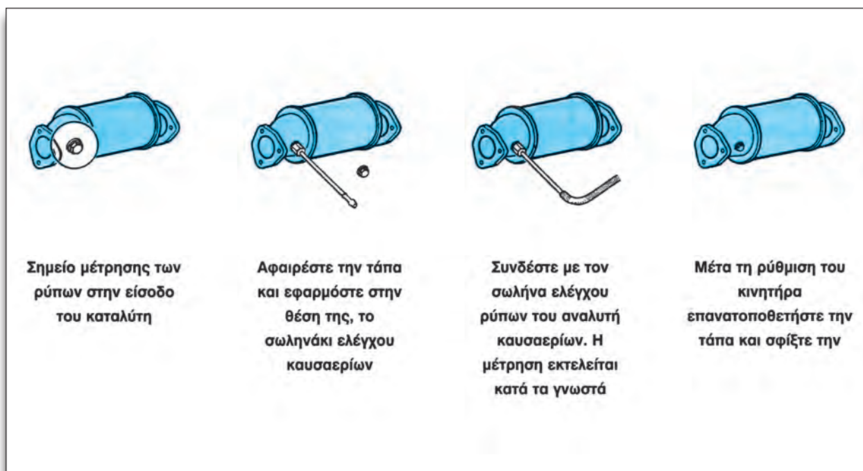
Σχήμα 3: Σημείο μέτρησης των ρύπων στον καταλύτη.
