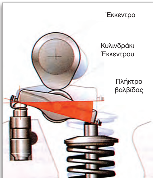
Εικόνα 2.3.4 Εκκεντροφόρος επικεφαλής, επιδρά στη βαλβίδα μέσω ζυγώθρου
