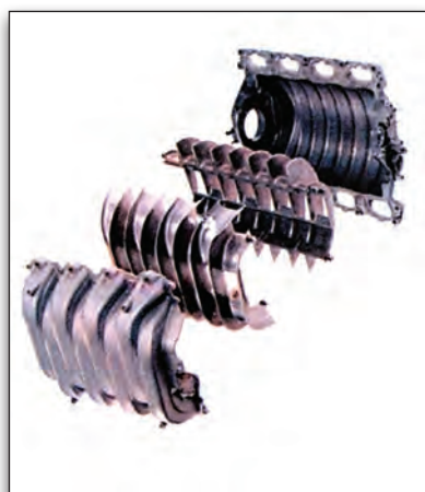
Εικόνα 2.4.6 Μεταβλητοί αυλοί εισαγωγής (Audi)
