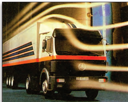
Εικόνα 8.2.2 Έλεγχος αεροδυναμικής συμπεριφοράς φορτηγού αυτοκινήτου σε αεροσήραγγα
