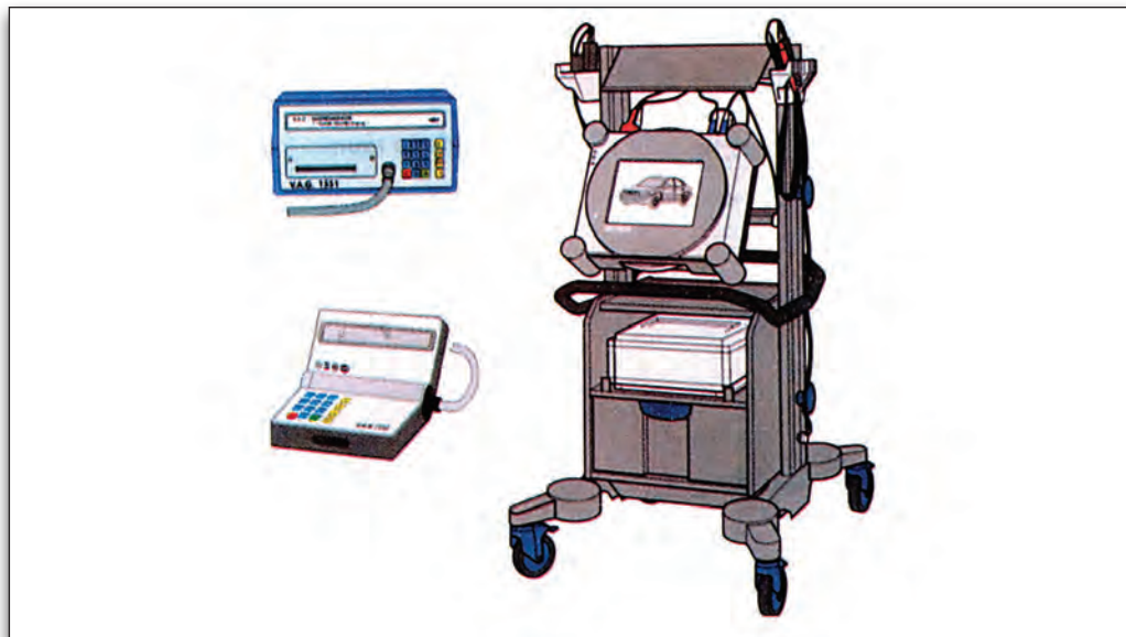
Εικόνα 5.14 Ειδικά τέστερ και εγκέφαλος αυτοδιάγνωσης βλαβών
