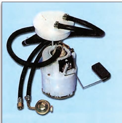
Εικόνα 3.1.10 Εμβαιπιζόμενη αντλία με δοχείο σταθεροποίησης
