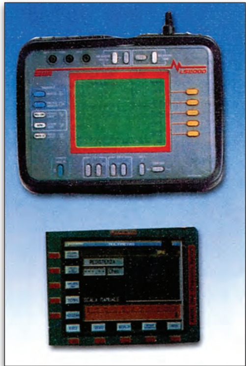
Εικόνα 5.6 Παλμογράφος αυτοδιάγνωσης και αποκωδικοποιητής – πολύμετρο
