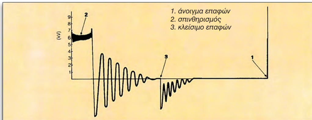
Εικόνα 5.8 Παλμογράφημα στο δευτερεύον κύκλωμα
