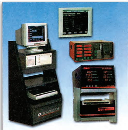
Εικόνα 5.3 Αναλυτές καυσαερίων πέντε αερίων με εκτυπωτές (κάτω)
