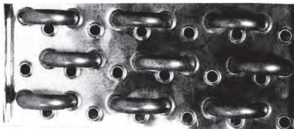
Σχήμα 8.35 Στοιχείο εξατμιστή στο οποίο φαίνονται οι οπές για τη διέλευση των ηλεκτρικών αντιστάσεων αποπαγοποίησης.
