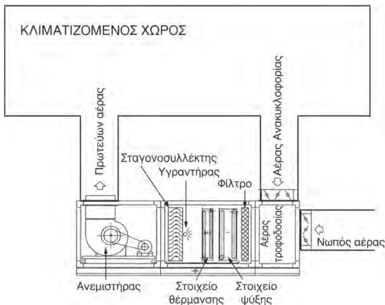
Σχήμα 7.11 Τυπική διάταξη λειτουργίας μίας ΚΚΜ χωρίς απορριπτόμενο αέρα
