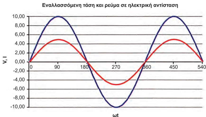
Σχήμα 2.4.2 Διάγραμμα τάσης – έντασης σε ηλεκτρική αντίσταση
