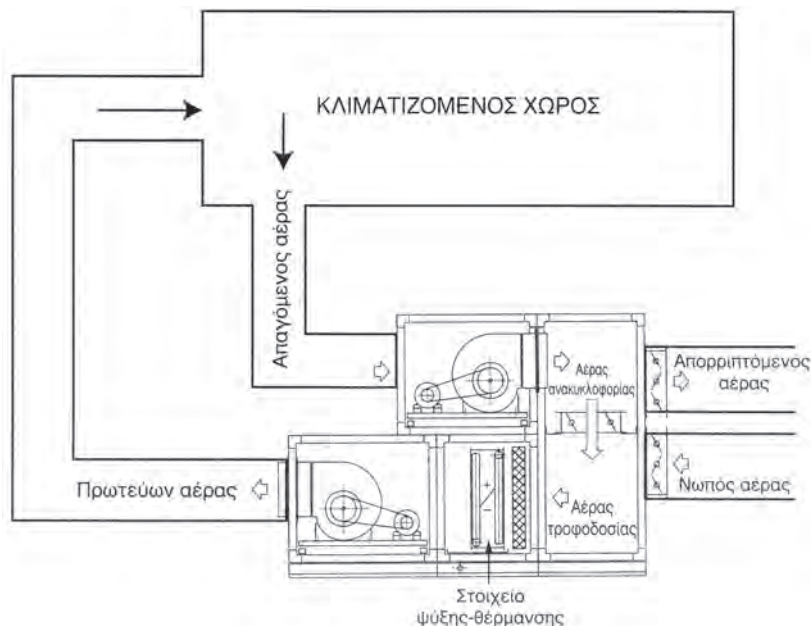
Σχήμα 7.12 Τυπική διάταξη λειτουργίας μίας ΚΚΜ με απορριπτόμενο αέρα
