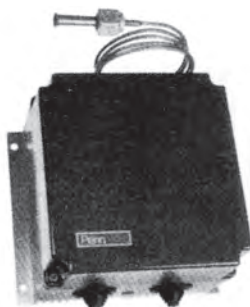
Σχήμα 5.26 Πρεσοστάτης ρύθμισης της πίεσης συμπύκνωσης, μέσω της ρύθμισης των στροφών του ανεμιστήρα
