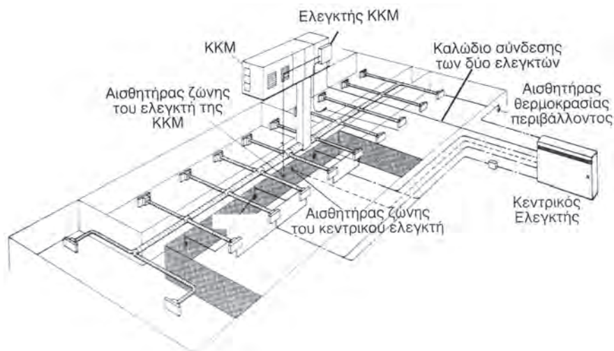
Σχήμα 7.25 Σχηματική παράσταση της διάταξης αυτοματισμού της λειτουργίας συστήματος VAV, εγκατεστημένης σε κτήριο
