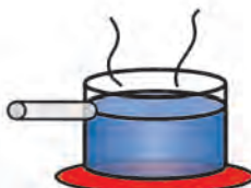
Εικόνα 1.28β: Αγωγιμότητα: Η μετάδοση της θερμότητας γίνεται από τα μόρια του ματιού της κουζίνας στα μόρια του πάτου της κατσαρόλας, λόγω της καλής επαφής μεταξύ τους
