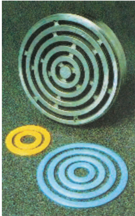
Εικόνα 2.25: Δακτυλιοειδείς βαλβίδες παλινδρομικών συμπίεστών
