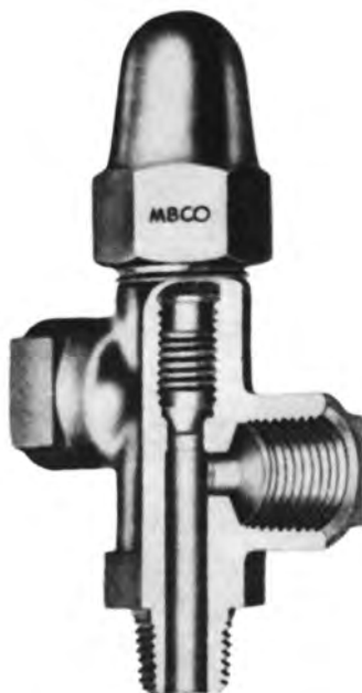
Εικόνα 7-15: Βαλβίδα Εισόδου Δοχείου Συμπύκνωσης με στόμιο για σύνδεση Ασφαλιστικής Βαλβίδας
