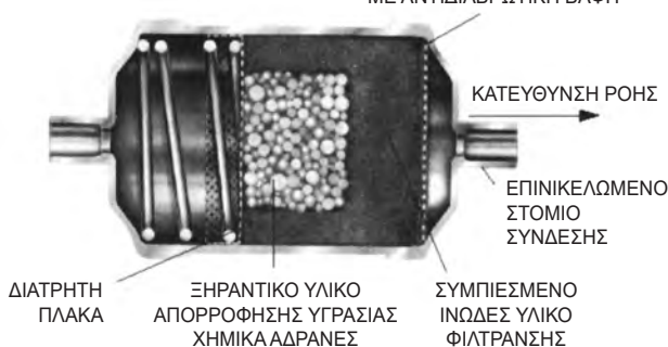
Εικόνα 7-3Β: Εξωτερική όψη και τομή Φίλτρου – Ξηραντή γραμμής υγρού
