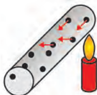
Εικόνα 1.28α: Αγωγιμότητα: Η μετάδοση της θερμότητας μέσα στη μάζα της ράβδου γίνεται από μόριο σε μόριο
