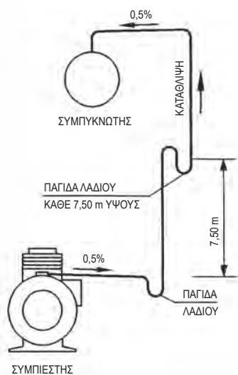
Εικόνα 9-12: Ο συμπυκνωτής υψηλότερα από το συμπιεστή με υψομετρική διαφορά μεγαλύτερη από 7,50 m
