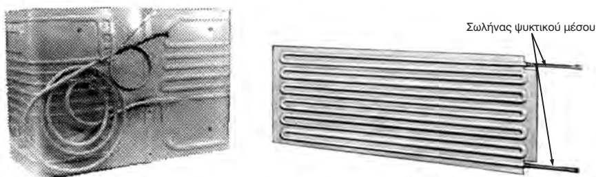
Σχήμα 20.1 Εξατμιστές με φυσική και εξαναγκασμένη ροή του αέρα
