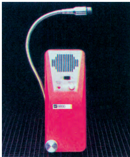
Σχήμα 5.3 Ηλεκτρονικός ανιχνευτής διαρροών για χλωροφθοράνθρακες (cfc's).
