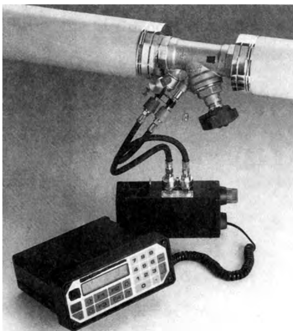
Σχήμα 18.2 Διάταξη μέτρησης της παροχής και της πίεσης μέσω ειδικών βανών
