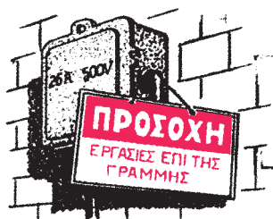
Σχήμα 14.3 Ταμπελάκι προειδοποίησης ότι γίνονται εργασίες στη γραμμή που ελέγχει ο διακόπτης
