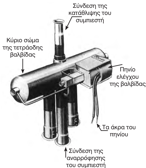
Σχήμα 15.1 Συνήθης εξωτερική μορφή τετράοδης βαλβίδας αντιστροφής του κύκλου λειτουργίας
