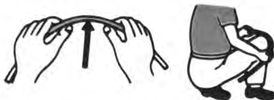
Σχήμα 4.6 Η διαμόρφωση του δικτύου των σωλήνων ψυκτικού με τα χέρια (χωρίς κουρμπαδόρο). Η ακτίνα κάμψης σ' αυτές τις περιπτώσεις δεν πρέπει να είναι μικρότερη των 100 mm
